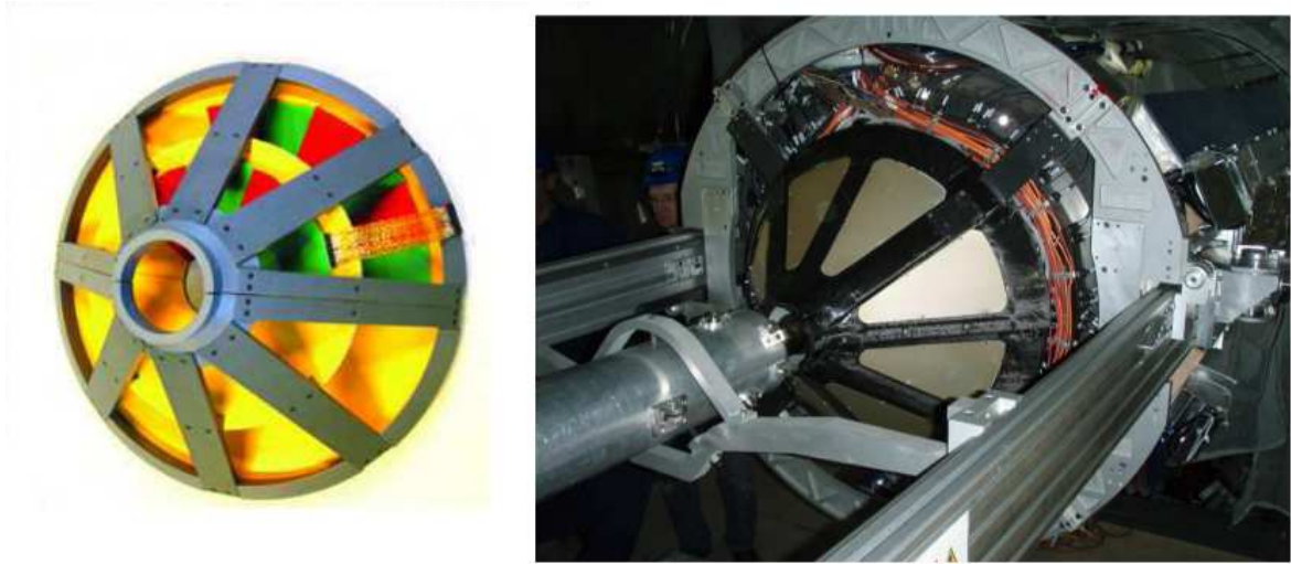
FIGURE 2.10 – Schéma du FMD (gauche) et photographie d’une partie du FMD installé (droite).
