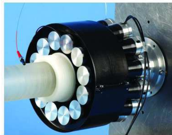
FIGURE 2.12 – Photographie du prototype du T0 C, les tubes photomultipliateurs (PMT) sont visibles autour du tube faisceau.
