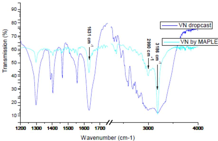
*Figure 51 : Les spectres FTIR pour une couche VN-tampon par « drop-cast » et VN-tampon déposée par MAPLE (Sima F. et al., 2011B).*
