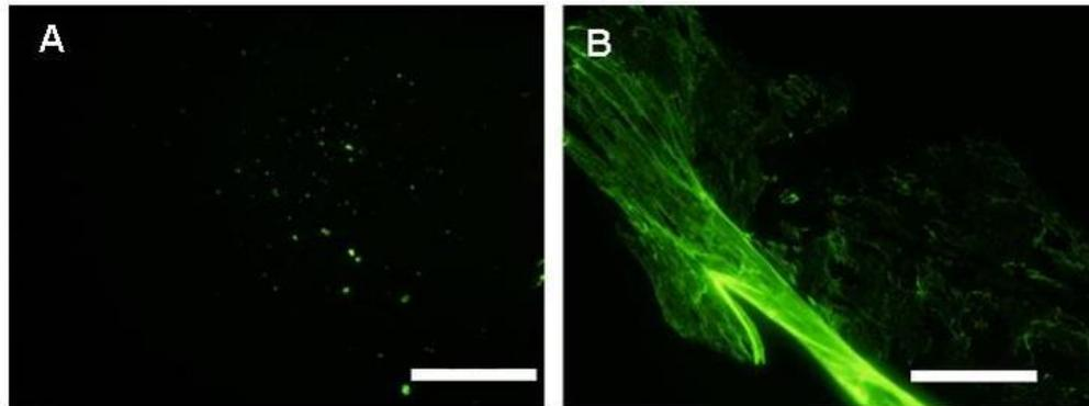
**Figure 55: Les images de microscopie en fluorescence des structures de la FN après transfert par MAPLE et immuno-marquage : régions avec des agrégats de FN (A) et structures fibrillaires de FN (B). Barre: 100  $\mu$ m.**
