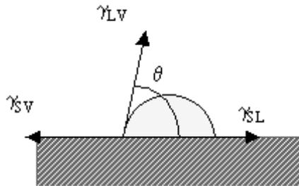
**Figure 30 : Schéma d'une goutte de liquide sur une surface solide.  $\theta$  est l'angle de contact,  $\gamma_{SV}$  la tension interfaciale solide-vapeur,  $\gamma_{SL}$  la tension interfaciale solide-liquide,  $\gamma_{LV}$  la tension interfaciale liquide-vapeur.**
