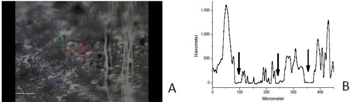
**Figure 49 : Images optique de la couche de VN (a) obtenue par MAPLE et son profil (b). L'évaluation de l'épaisseur a été faite par des rayures fines faites dans le dépôt (les flèches en B). On estime une épaisseur de  $500 \pm 120$  nm qui correspond à un dépôt de  $0.3 \pm 0.08 \text{ \AA}$  par pulse laser.**
