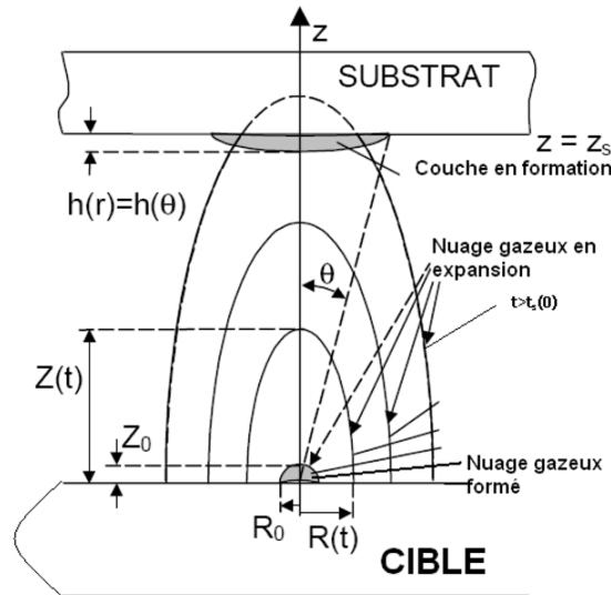
**Figure 19 : Schéma de l'expansion de plasma et formation de couches minces.  $t_0$  est le temps initial de formation du plasma,  $Z_0$  la longueur initiale de plasma,  $R_0$  – le rayon de plasma qui coïncide avec celui du spot laser,  $h(r,t) = h(\theta,t)$  le profil de la couche,  $r$  et  $\theta$  sont respectivement la coordonnée et l'angle radial où  $\theta = \arctan(r/z_s)$  (Anisimov SI et al., 1993)**
