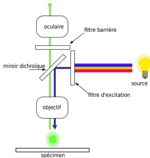
**Figure 36 : Schéma du fonctionnement d'un microscope à épifluorescence**
