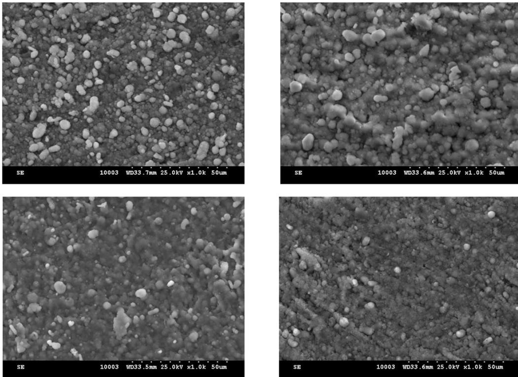
**Figure 40 : Images MEB de la couche d'HA obtenue par PLD sur Ti aux différentes fluences laser: (a) 2, (b) 3, (c) 5 and (d) 7.5 J/cm<sup>2</sup>**
