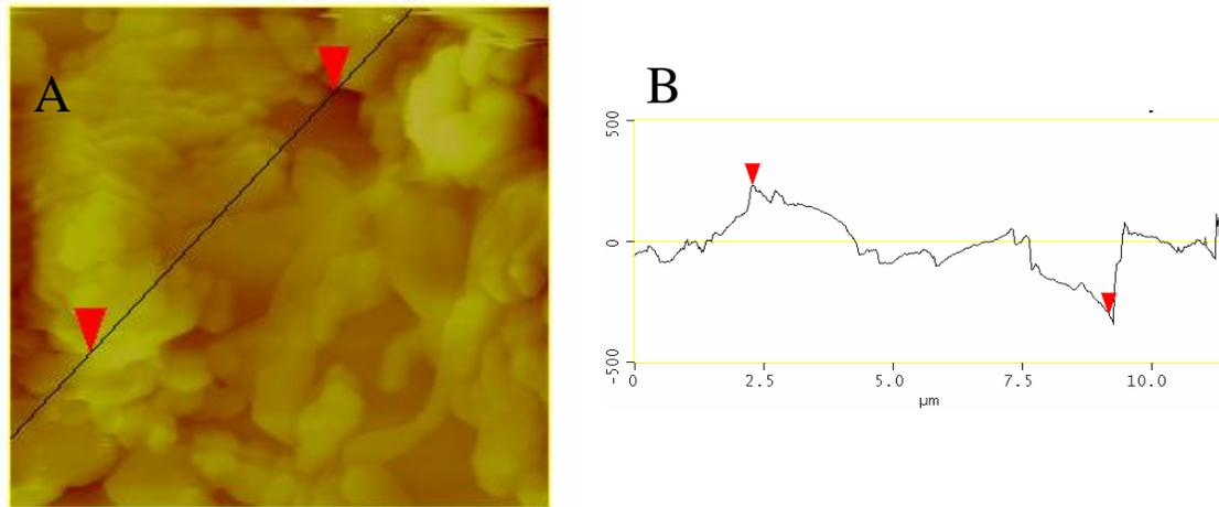
**Figure 54 : Image AFM de la couche VN-tampon (A) et profil AFM (B) pour l'image de la couche VN-tampon. On estime une hauteur d'environ 157.08 nm entre les régions les plus élevées et les régions les plus basses (Sima F et al, 2011B).**
