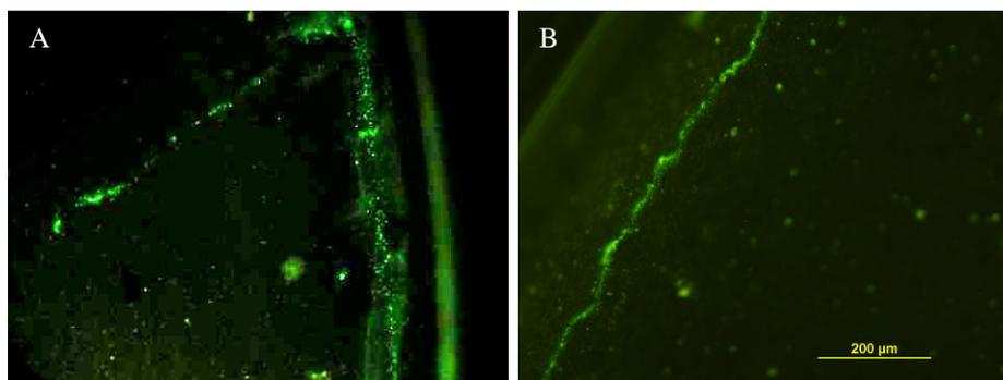
**Figure 57: Les images de microscopie en fluorescence des structures après le transfert par MAPLE et l'immuno-marquage : régions avec des agrégats de VN (A) et structures d'ASB (B). Barre : 200  $\mu\text{m}$ .**
