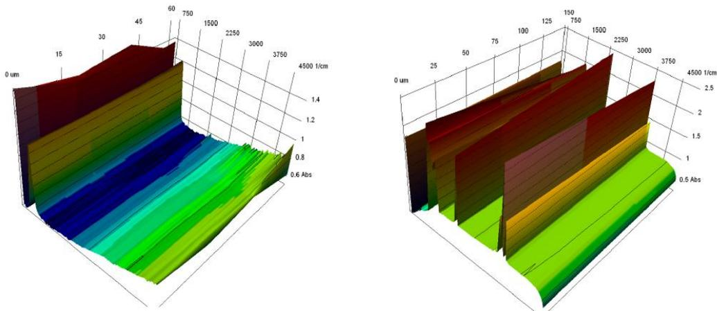
***Figure 52 : Les spectres 3D AIM FTIR pour une couche HA sur Si (gauche) et FN-tampon déposée par MAPLE sur une structure Si/HA (droite). Le vert représente une absorption faible tandis que le rouge représente une absorption élevée***
