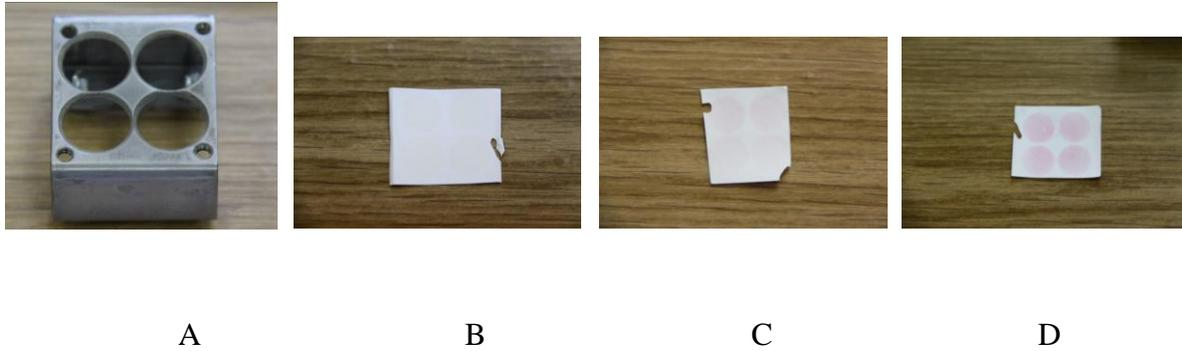
***Figure 45: Révélation par le Ponceau S de la protéine transférée (ASB) sur le papier de nitrocellulose à travers un masque présentant quatre ronds de 12 mm de diamètre : le masque utilisé (A), révélation de l'ASB transférée d'une solution à 0.1 mg/ml (B), 0.25 mg/ml (C) et 1 mg/ml (D).***
