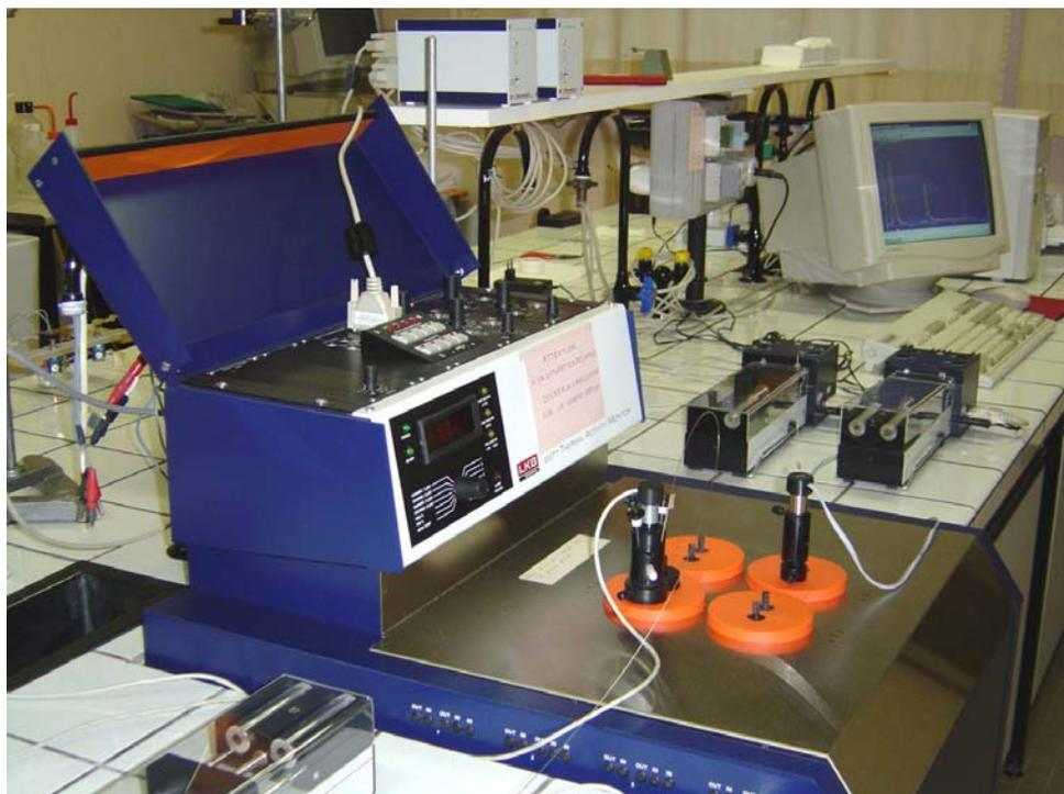
Figure S.2: Calorimètre 2277 TAM (Thermometric - LKB)
