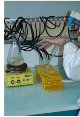
Figure C.16: Après ajouts du réducteur et éventuellement de la solution tampon de bicarbonate de sodium, les milieux de culture sont répartis en tubes de Hungate ou de Balch sous atmosphère CO 2 ou N 2 .
