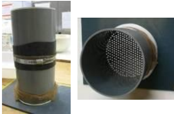
Figure 2.3 : Assemblage des cylindres et plaque de support
