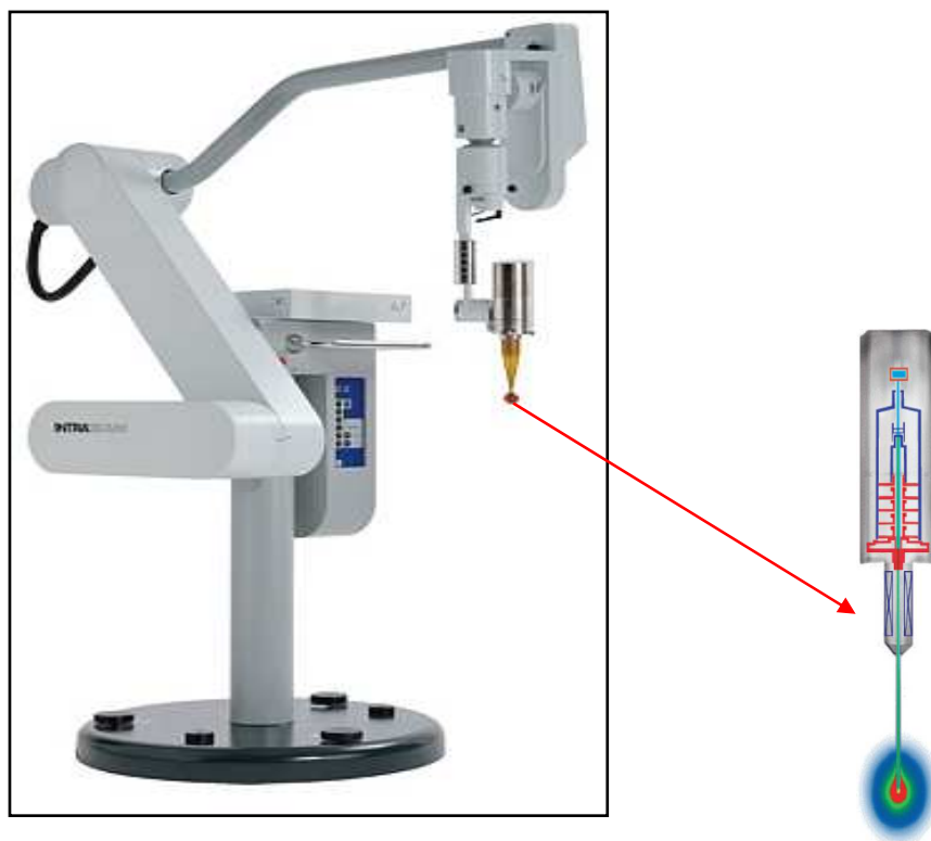
Figure 1.6. (a) Dispositif d'irradiation per-opératoire par photons de basse énergie (Targit); (b) Tube de rayonnement X.
