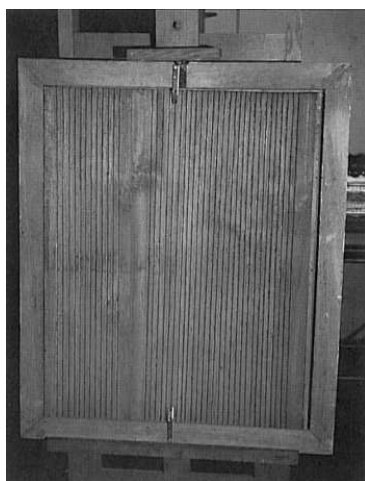
FIG. 1.12 – Saignées verticales et raffinage de l'épaisseur du tableau [13]
