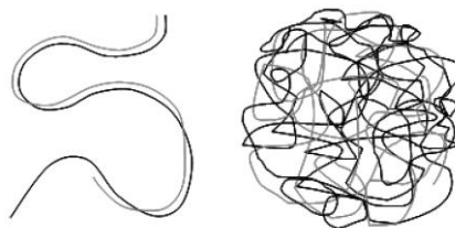
Figure 12 : Représentation schématique des structures en échelle (gauche) et œufs brouillés (droite)
