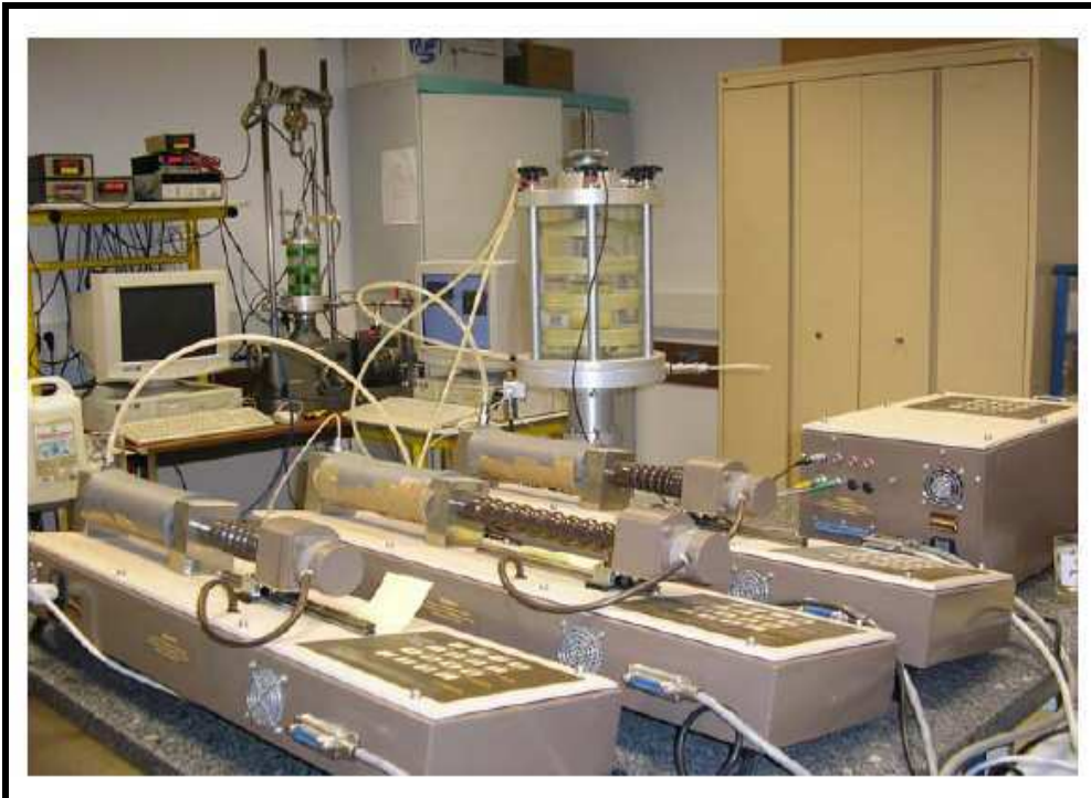
Figure V-67 : Cellule triaxiale équipée de contrôleurs pression-volume
