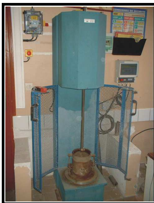
Figure III-11: Matériel et méthode de réalisation des essais Proctor
