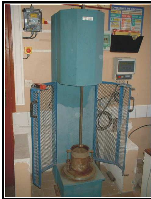
Figure III-11: Matériel et méthode de réalisation des essais Proctor
