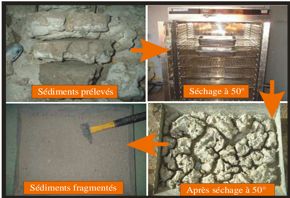
Figure IV-11 : Aspect visuel des différents états des sédiments avant traitement
