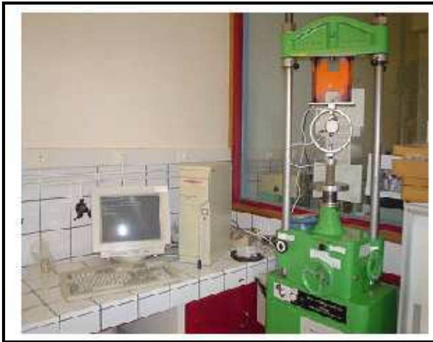
Figure V-17 : Dispositif expérimental d'essai en compression simple
