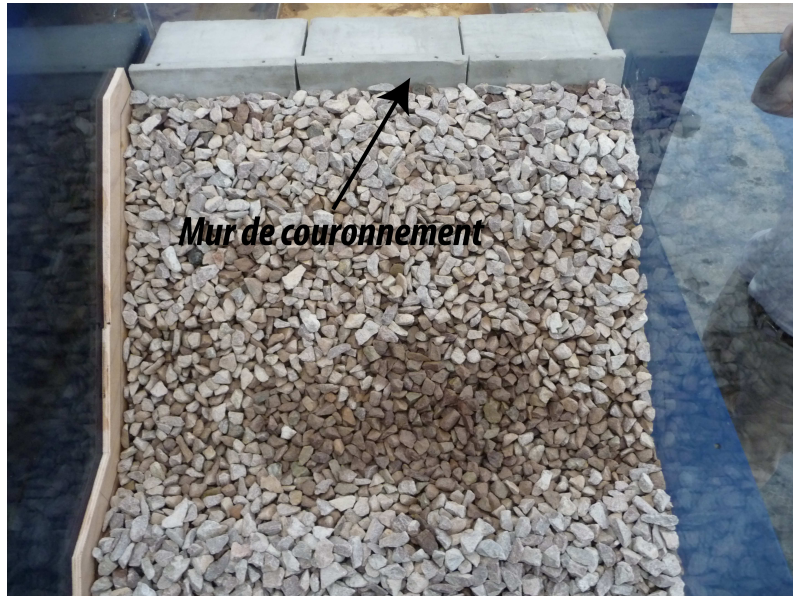
FIG. III.4: Mur de couronnement en béton
