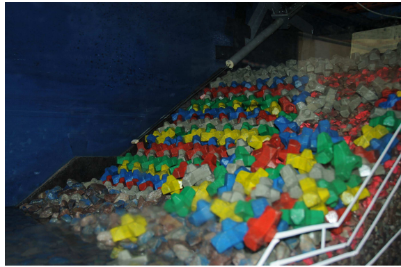
(b) Configuration du plan de pose après les dommages
