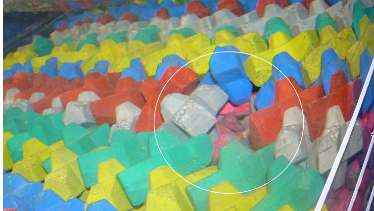
FIG. IV.44: Perte de matériaux de la sous-couche à partir d'une cavité induite par les dommages
