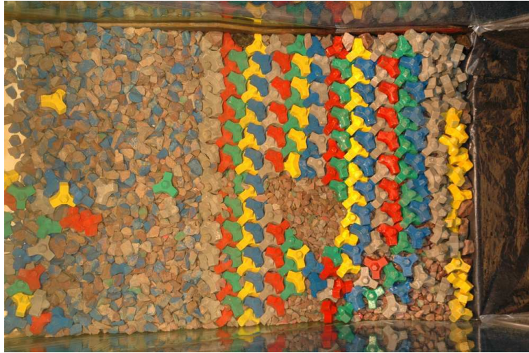
FIG. IV.23: Dommages confinés sur une zone limitée
