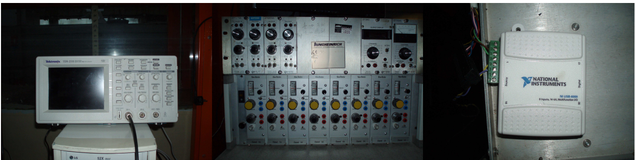
FIG. II.16: Dispositifs d'acquisition pour la mesure des efforts (oscilloscope, conditionneurs, convertisseur)
