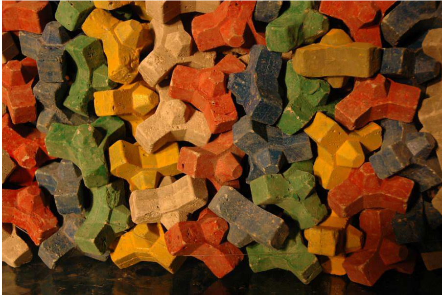
FIG. IV.7: Pose de blocs posés sur un plan de pose aléatoire (PDPA)
