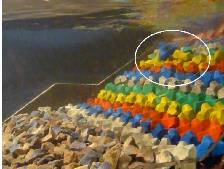
FIG. IV.47: Balancement et roulement de blocs conduisant à une rupture de carapace
