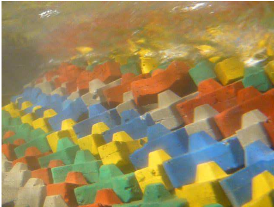
FIG. IV.26: Soulèvement d'un bloc posé sur un plan de pose 'rangé'
