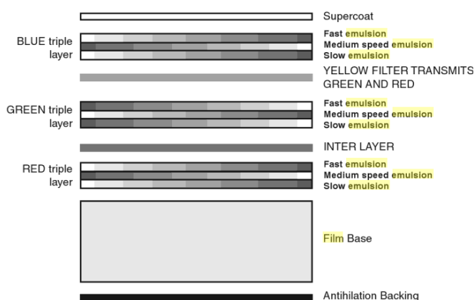
Illustration 52 Schéma en coupe d'une copie film.
