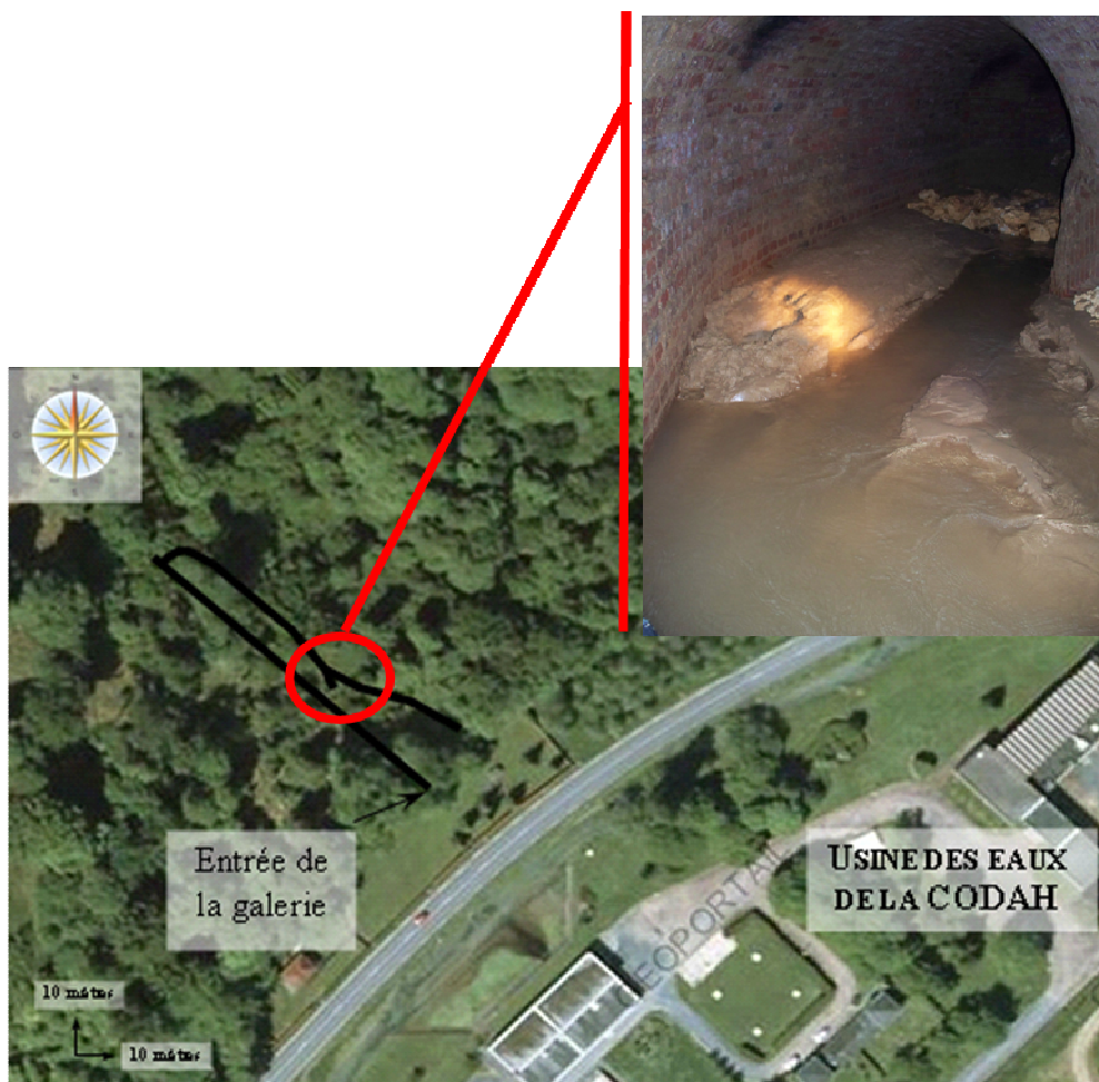
Figure II- 21 : Localisation du bras abandonné de la galerie captante de la source de la Bruisseresse
