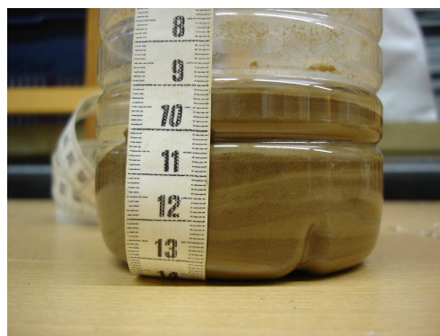
Photo I- 7 : Piège à sédiment mis en place au niveau des trois sources étudiées permettant de piéger les matières en suspension
