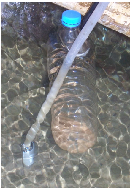
Photo I- 7 : Piège à sédiment mis en place au niveau des trois sources étudiées permettant de piéger les matières en suspension
