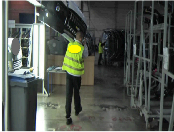
Figure 8 : illustration de la manière de porter le pare-choc à l'encyclage par M. FB
