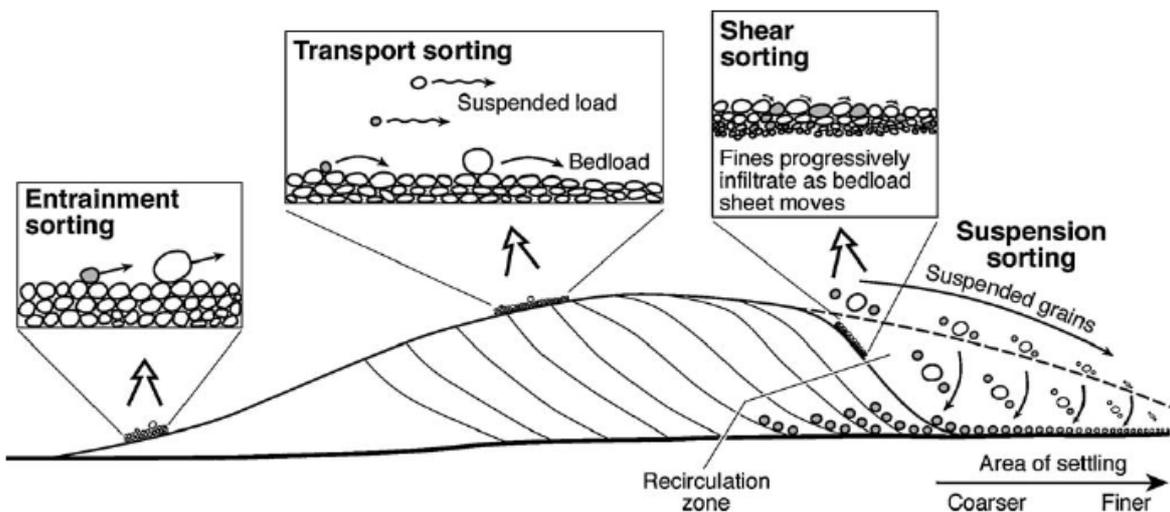
Figure 1.20 Mécanisme de tri de particules hétérogènes (Carling et Breakspear, 2006)
