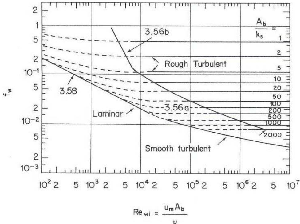
**Figure 1.15** Variation du facteur de frottement  $f_w$  en fonction du nombre de Reynolds lié aux vagues et de l'excursion relative des particules au fond  $A/k_s$  (d'après Jonsson, 1966 dans Dyer, 1986).  $k_s$  est le coefficient de Nikuradse (voir paragraphe 1.5.2.).
