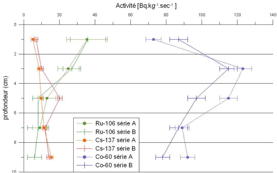
**Figure 3.50** Profils d'activité de Ru-106, Cs-137 et Co-60 mesurés au point Job (au Sud du Nez de Jobourg). L'erreur sur la mesure au spectromètre gamma est indiquée (intervalle de confiance de 95%). Les séries A et B correspondent à deux séries d'échantillons.
