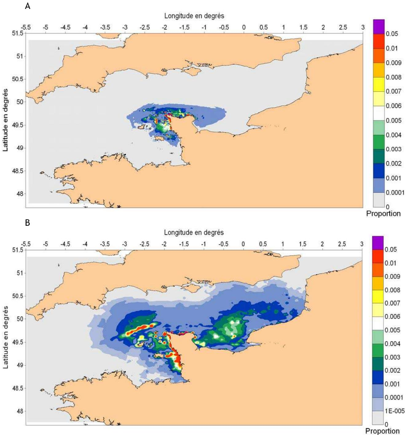
**Figure 6.37** Simulation du panache de dispersion de particules de vase ( $D = 0.03$  mm) potentiellement marquées au Cap de la Hague. Proportion de particules marquées dans la couche active. A : Au bout d'un an (modèle M10). B : Au bout de cinq ans (modèle M40).
