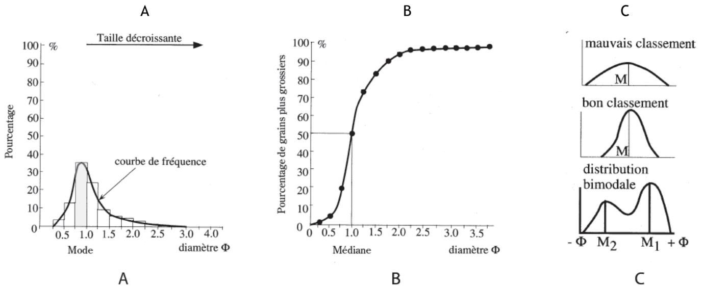
**Figure 1.1 Représentations de courbes granulométriques (Chamley, 2006). A : La courbe de fréquence (obtenue à partir du pourcentage massique de chaque classe) fait apparaître le mode. B : La courbe granulométrique obtenue à partir des fréquences cumulées permet de déterminer les diamètres caractéristiques. C : Courbes de fréquence d'un échantillon mal classé, bien classé et d'un échantillon bimodal.**
