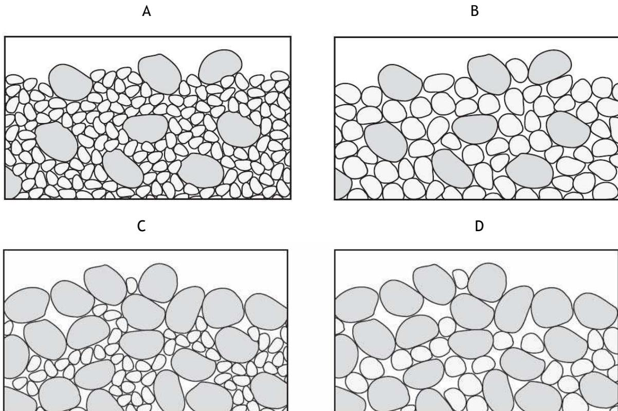
**Figure 2.5** Schémas d'arrangements de mélanges bimodaux A : Mélange saturé de sables fins et grossiers (mélange SG/SF). B : Mélange saturé de sables moyens et grossiers (mélange SG/SM). C : Mélange non saturé (et pavé) de sables fins et grossiers (mélange SG/SF). D : Mélange non saturé (et pavé) de sables moyens et grossiers (mélange SG/SM).
