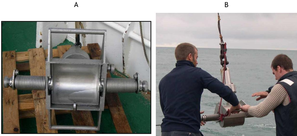
**Figure 3.7** Benne Shipeck (prélèvement sédimentaire). A : benne armée. B : benne déclenchée après prélèvement.
