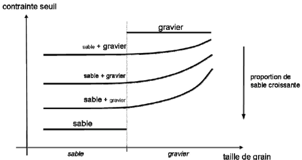
Figure 5.3 Contraintes seuil pour un mélange bimodal sable-gravier : tendances schématisées (De Linares, 2007).
