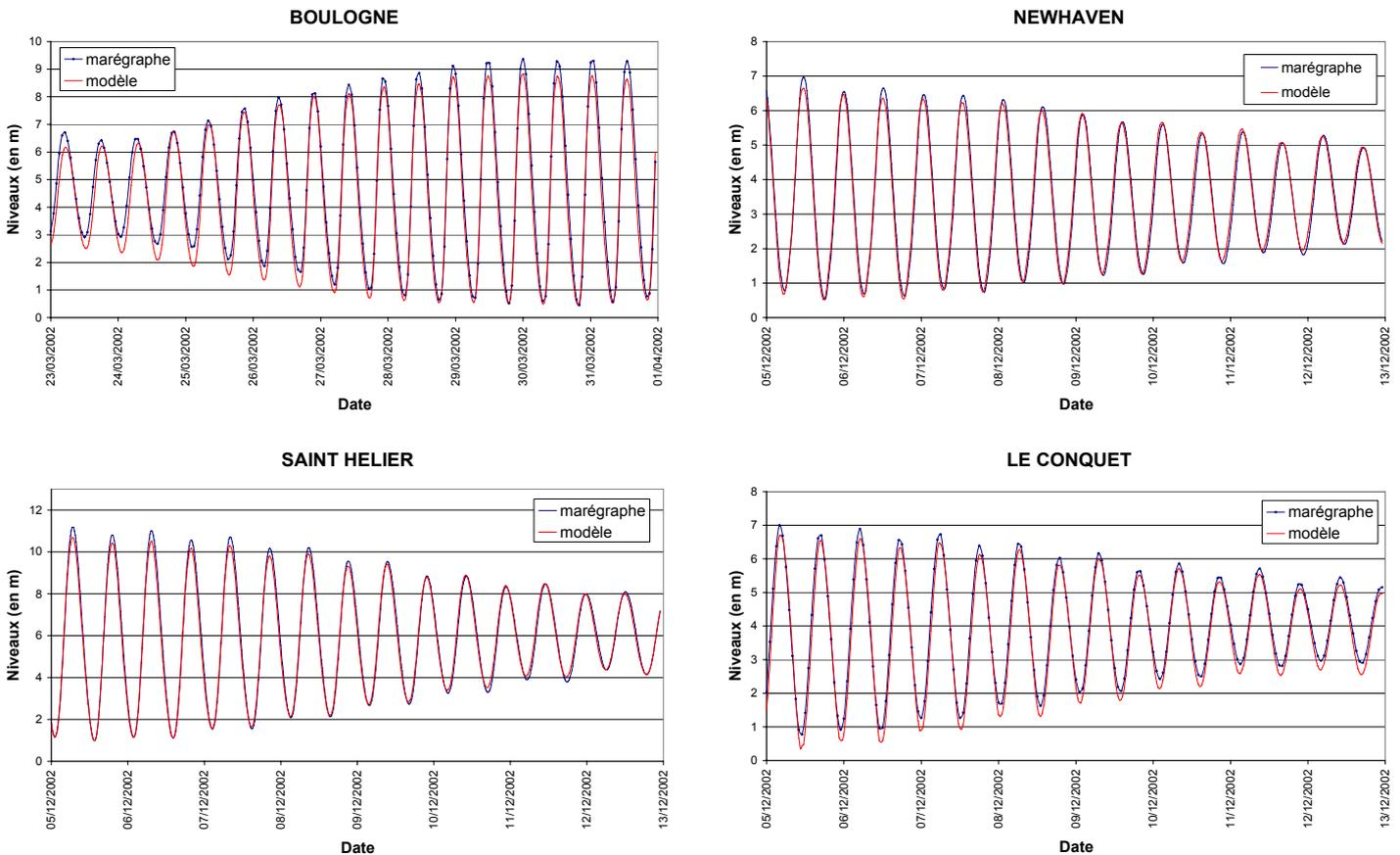
**Figure 6.4 Niveaux d'eau : comparaison des résultats du modèle M40 et des mesures en 4 points de la Manche, d'Est en Ouest [origine des données : BODC (British Oceanographic Data Centre) et SONEL (Système d'Observation du Niveau des Eaux Littorales)].**
