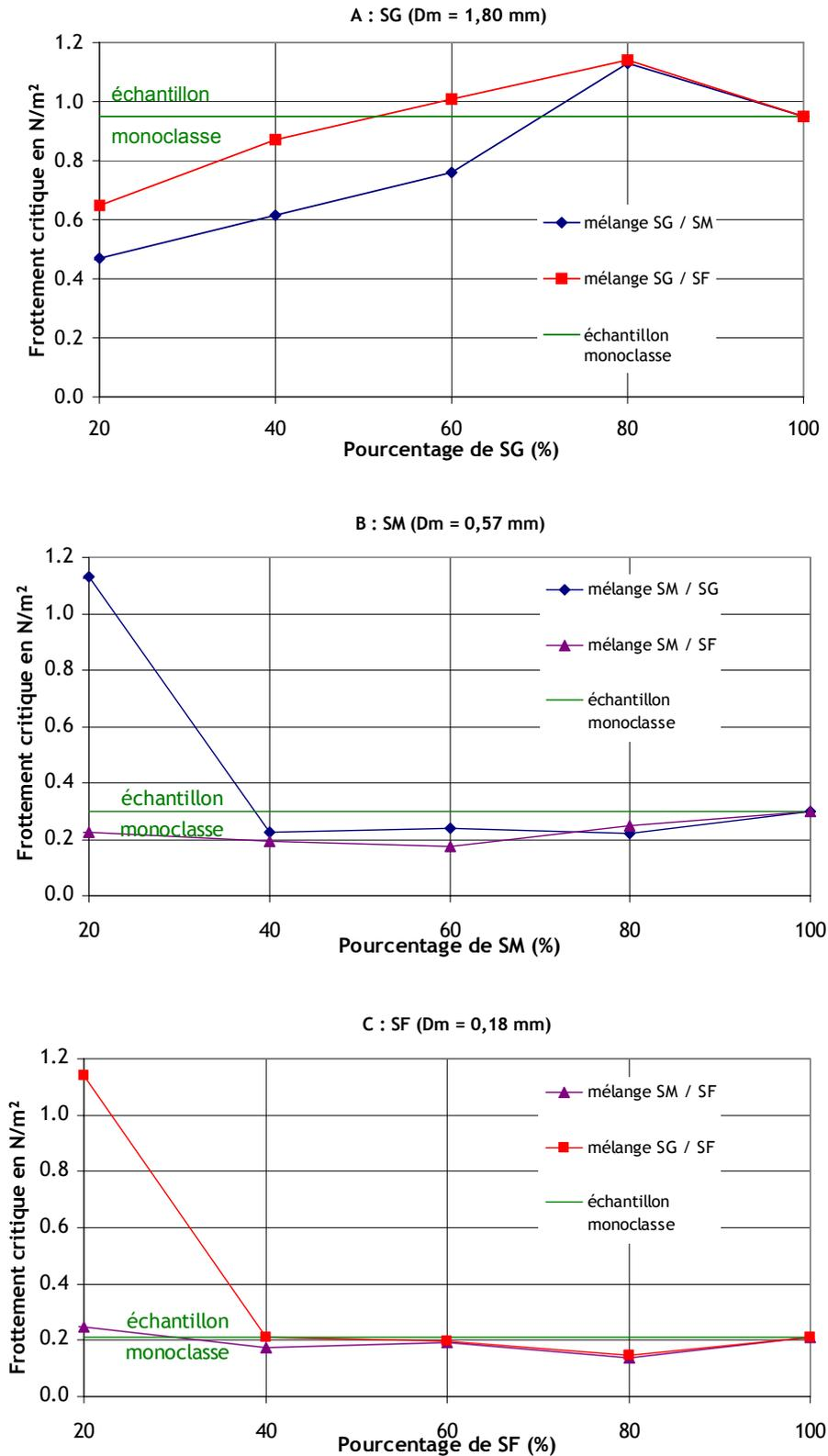
**Figure 2.3** *Contrainte de frottement critique d'une classe en fonction de la composition du mélange bimodal. A : Pour la classe SG ( $D_m = 1,80$  mm). B : Pour la classe SM ( $D_m = 0,57$  mm). C : Pour la classe SF ( $D_m = 0,18$  mm). Les droites vertes représentent la contrainte critique pour un échantillon monoclasse.*
