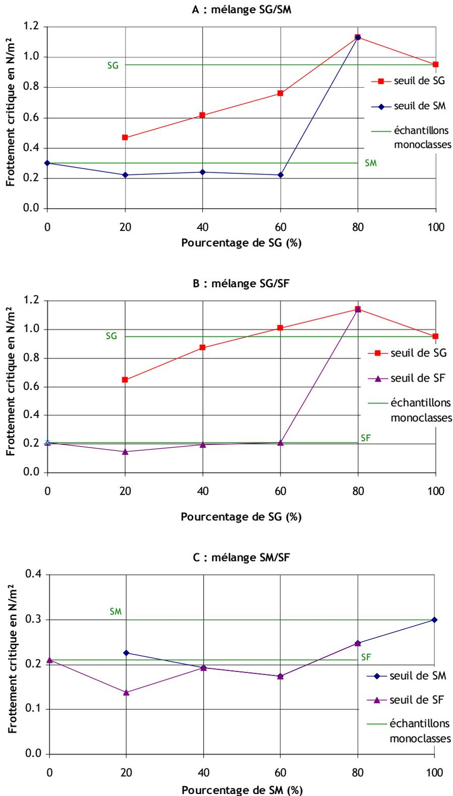
**Figure 2.4** *Contrainte de frottement critique des deux classes d'un même mélange en fonction de la composition du mélange. A : Pour le mélange SG/SM. B : Pour le mélange SG/SF. C : Pour le mélange SM/SF. Les droites vertes représentent la contrainte critique pour un échantillon monoclasse.*
