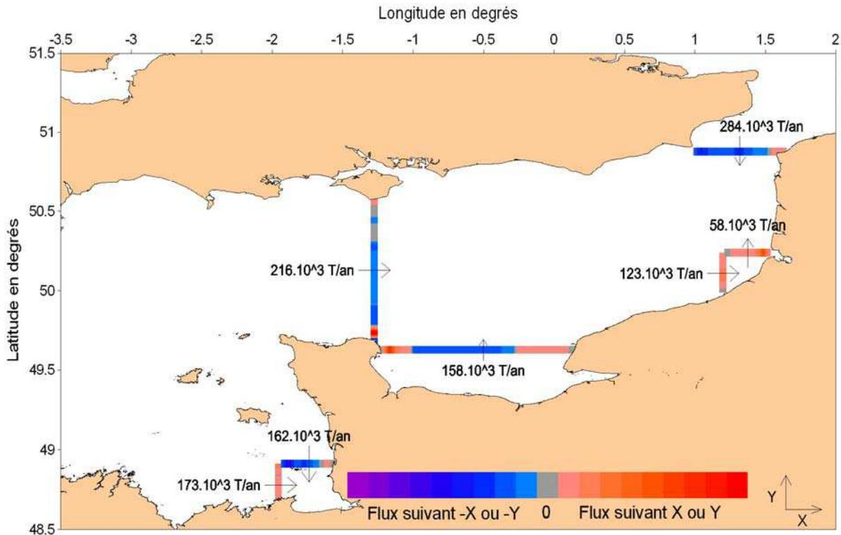
**Figure 6.28** Flux résiduel de toutes les classes de tailles confondues, sans prise en compte de l'effet des vagues. Les valeurs représentent le flux net traversant la section dans le sens indiqué par la flèche. Les couleurs indiquent la contribution spatiale au flux : les tons rouges révèlent une contribution dans le sens positif (X ou Y), les tons bleus une contribution négative.
