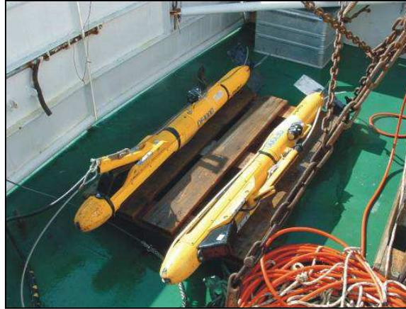
**Figure 3.5** Deux sonars à balayage latéral Edgetech DF1000.
