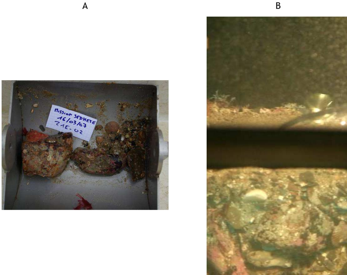
Figure 3.13 Faciès sédimentaire de la station atelier Job. A : Prélèvement à la benne Shipeck. B : Image prise par le DySPI (vue en coupe dans la partie haute de l'image, vue de dessus dans la partie basse).
