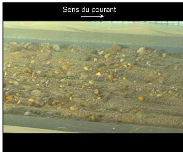
**Figure 1.6** Sillages générés à l'aval de grains immobiles (Olivier, 2004)
