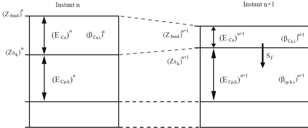
Figure 5.5 Érosion avec remontée du fond de la couche active (d'après Cugier, 2000).
