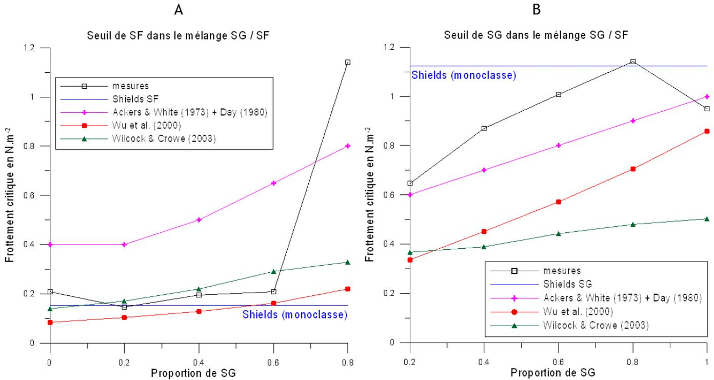
**Figure 6.23** Frottement critique des deux classes d'un mélange SG/SF : comparaison des mesures et des résultats de plusieurs formulations. A : Seuil de la classe SF. B : Seuil de la classe SG.
