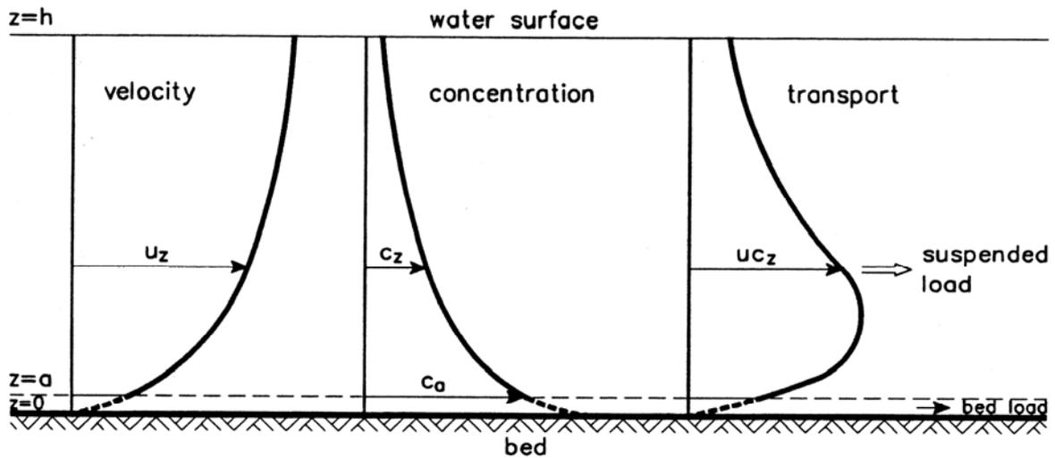
Figure 1.19 Schématisation du calcul du flux transporté en suspension (Van Rijn, 1993)
