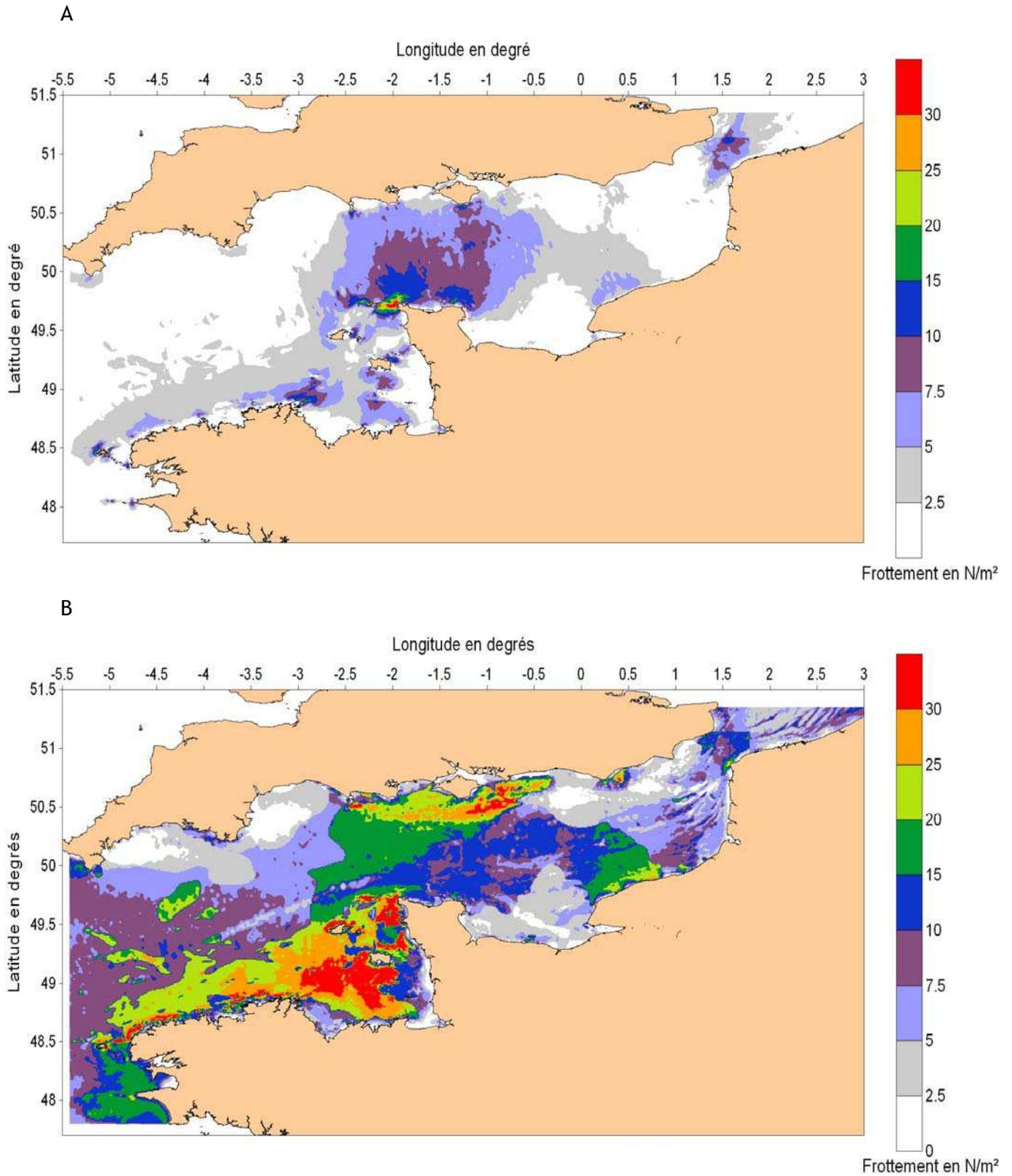
**Figure 6.16** Cartes des contraintes de frottement de peau maximales atteintes en Manche durant l'année 2007 issue du modèle M10. A : Contraintes dues au courant seul. B : Contraintes dues à l'action des vagues et du courant.
