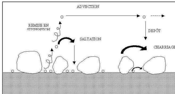
Figure 1.7 Illustration des différents modes de transport (Cugier, 2000)
