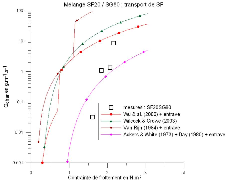
Figure 6.26 Flux charriés de la classe SF dans le mélange pavé SG80/SF20 : comparaison des mesures et des résultats de plusieurs formulations.
