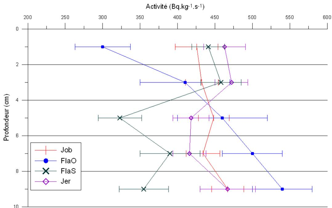
**Figure 3.53** Profils d'activité de K-40 mesurés aux quatre stations. L'erreur sur la mesure au spectromètre gamma est indiquée. Les séries A et B du point Job correspondent à deux séries d'échantillons.
