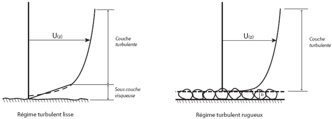
**Figure 1.5** Profil de vitesse du courant en régime turbulent lisse et en régime turbulent rugueux.
