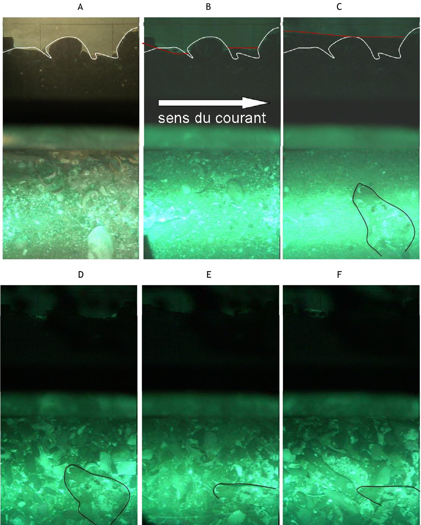
**Figure 3.30** Images acquises par le système DySPI au point FlaO. Sur les images A, B et C, le trait blanc marque la position initiale de l'interface, le trait rouge sa position instantanée. Les contours du même galet sont marqués d'un trait noir sur les images C, D, E et F.
