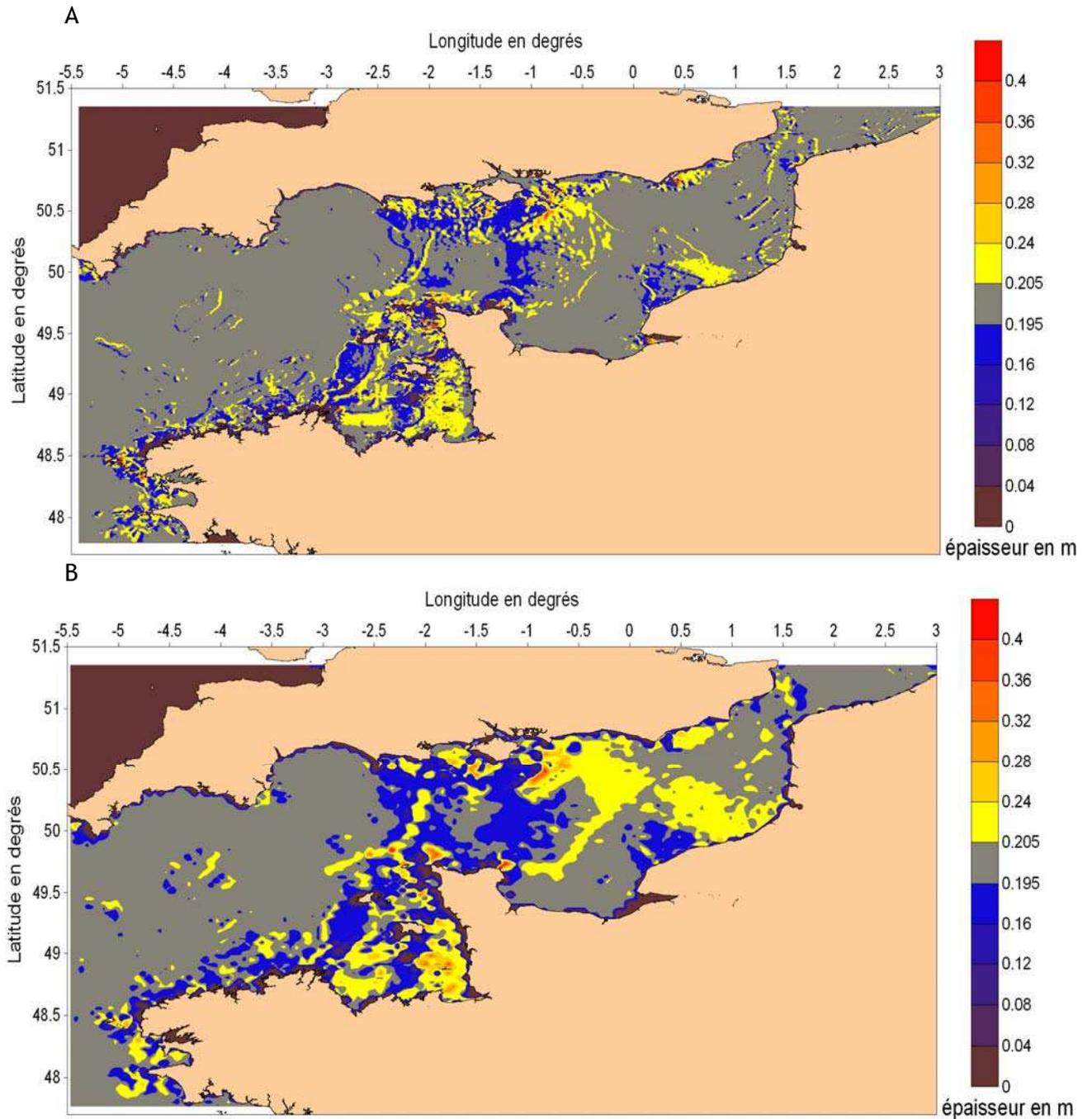
Figure 6.33 Evolution de l'épaisseur de la couche sédimentaire (l'épaisseur initiale a été fixée à 20 cm). A : Au bout de un an (modèle M10). B : Au bout de cinq ans (modèle M40).
