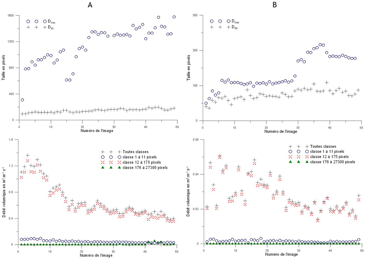
**Figure 3.36** *Séries temporelles sur 50 images du diamètre maximal mis en mouvement, du  $D_{95}$  en mouvement et du débit volumique transporté pour trois classes de taille lors de deux séquences filmées.*
