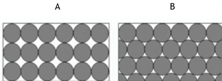
**Figure 1.3** Arrangement de sphères parfaites. **A : Assemblage cubique.**
