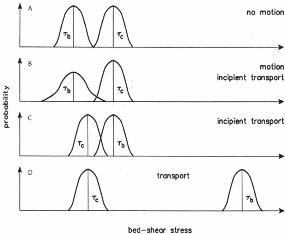
**Figure 1.9** Approche stochastique de la mise en mouvement (Grass, 1970). A : Pas de mouvement, les fonctions de probabilités des contraintes ne se chevauchent pas. B et C : Mise en mouvement. D : L'excès de frottement est important, le transport est général.
