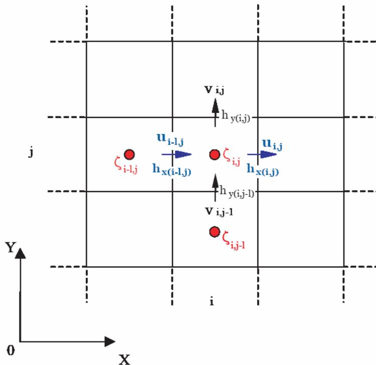
Figure 5.1 Position des points de calcul sur le maillage.
