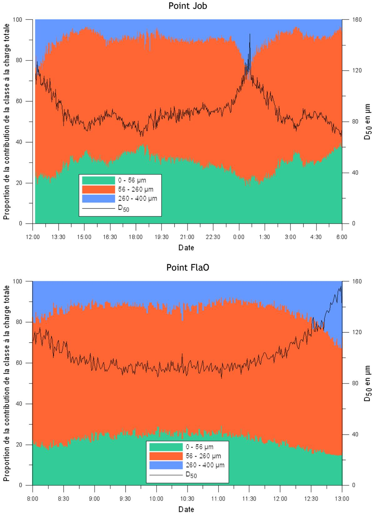
**Figure 3.44** Série temporelle de la contribution (en pourcentage) de trois intervalles de classes granulométriques à la concentration en MES mesurée avec le granulomètre laser et série temporelle du diamètre médian  $D_{50}$  des particules en suspension aux stations Job et FlaO.
