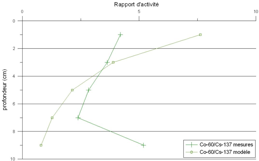
**Figure 3.59** Comparaison des profils d'activité mesuré et calculé par le modèle pour le rapport Co-60/Cs-137 au point Jer. Le rapport de partage  $RK_d$  est fixé à 59.
