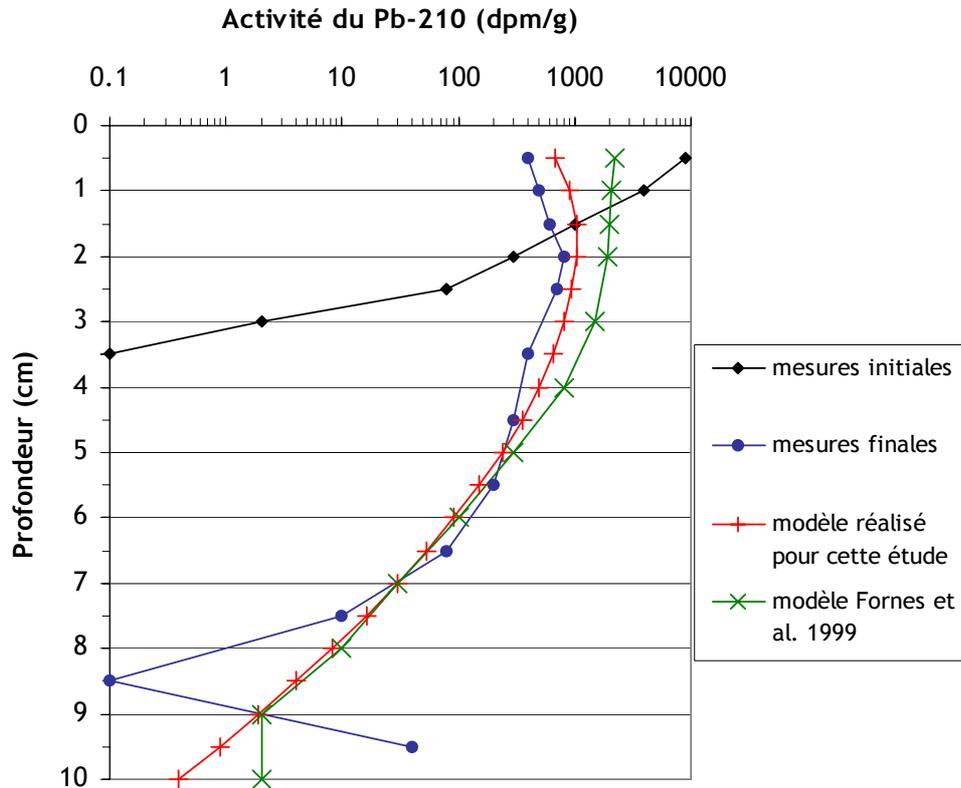
**Figure 3.55** Profil d'activité du Pb-210 : état initial mesuré, état final mesuré, état final calculé par le modèle de Fornes et al. (1999) et état final calculé par la modèle présenté dans cette étude.
