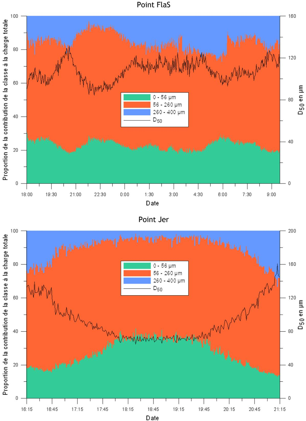
**Figure 3.45** Série temporelle de la contribution (en pourcentage) de trois intervalles de classes granulométriques à la concentration en MES mesurée avec le granulomètre laser et série temporelle du diamètre médian  $D_{50}$  des particules en suspension aux stations FlaS et Jer.
