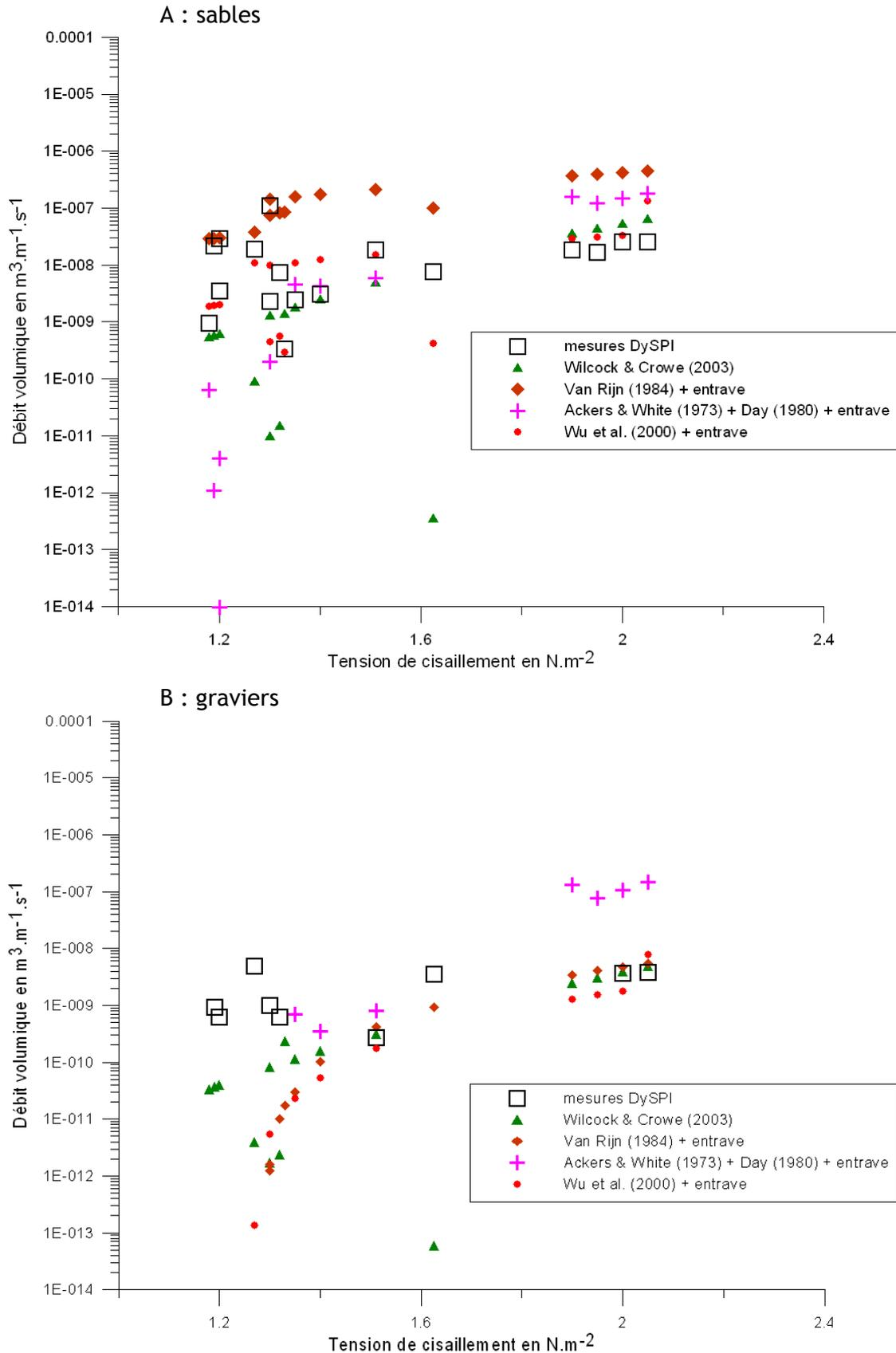
**Figure 6.20** Flux charriés avec prise en compte du coefficient d'entrave (sauf pour Wilcock et Crowe) : comparaison des mesures et des résultats des formulations sélectionnées. A : Flux de sables. B : Flux de graviers.
