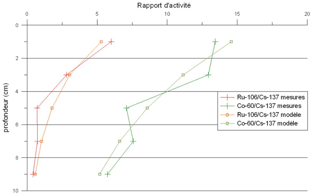
**Figure 3.57** Comparaison des profils verticaux d'activité mesurés et calculés au point Job pour un indicateur du temps de résidence de  $24 \text{ mois}^{-1}$  et un coefficient de mélange de  $0,55 \text{ cm}^2.\text{mois}^{-1}$ .
