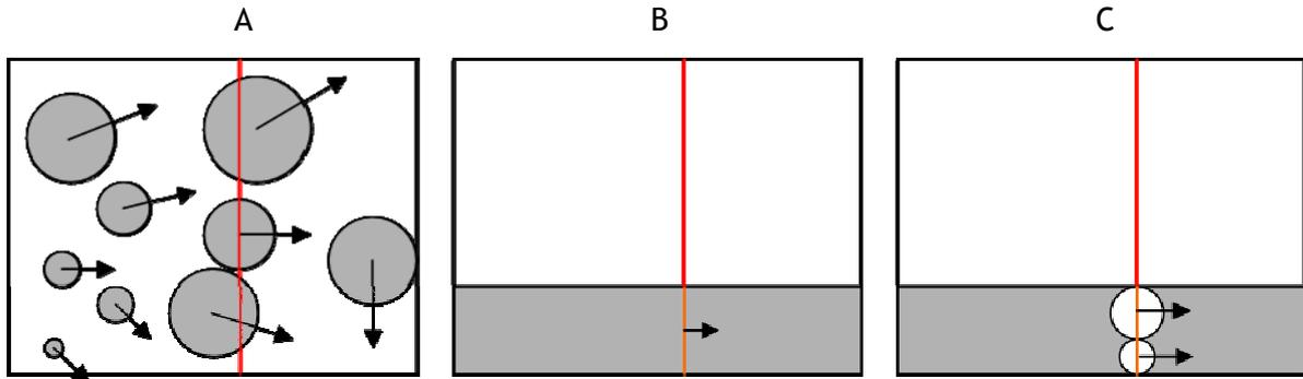
**Figure 3.35** Schématisation de l'analyse et des hypothèses réalisées pour traiter les images acquises par le DySPI. A : Décompte de la surface en mouvement. B : La proportion de surface en mouvement égale la proportion de longueur en mouvement en chaque ligne de la surface. C : La proportion de longueur en mouvement est la somme des diamètres des particules.
