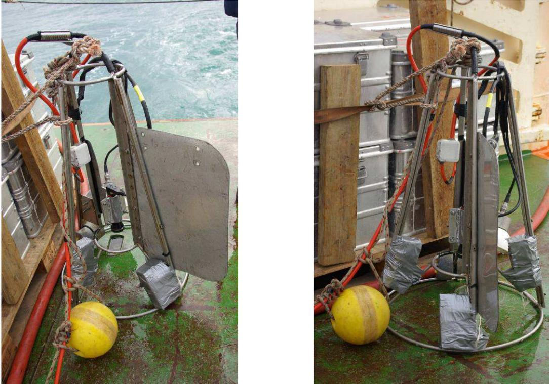
Figure 3.8 Bâti supportant et protégeant la caméra.
