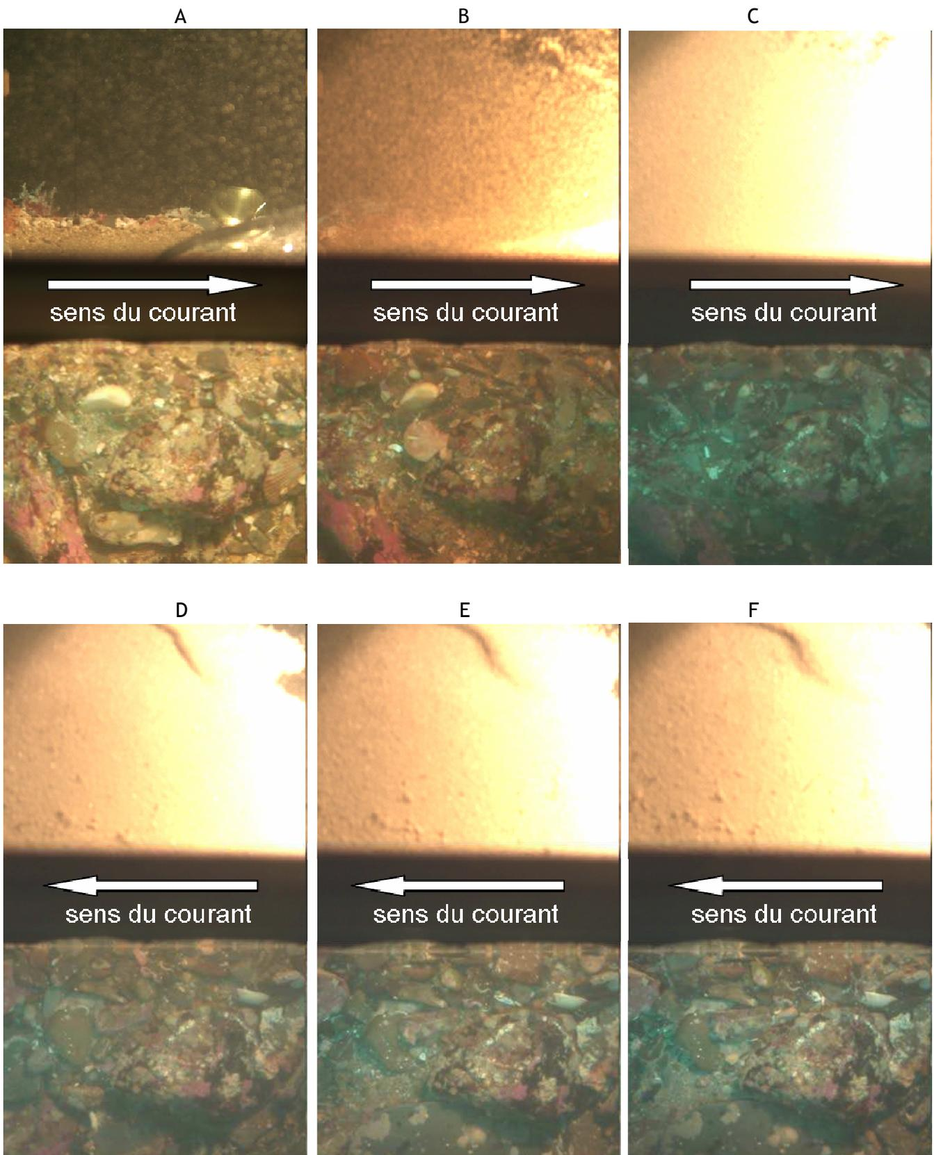
**Figure 3.28** Images acquises par le système DySPI au point Job. Vue en coupe dans la partie haute de l'image, vue de dessus dans la partie basse, la bande noire au milieu est une partie du boîtier périscope étanche.
