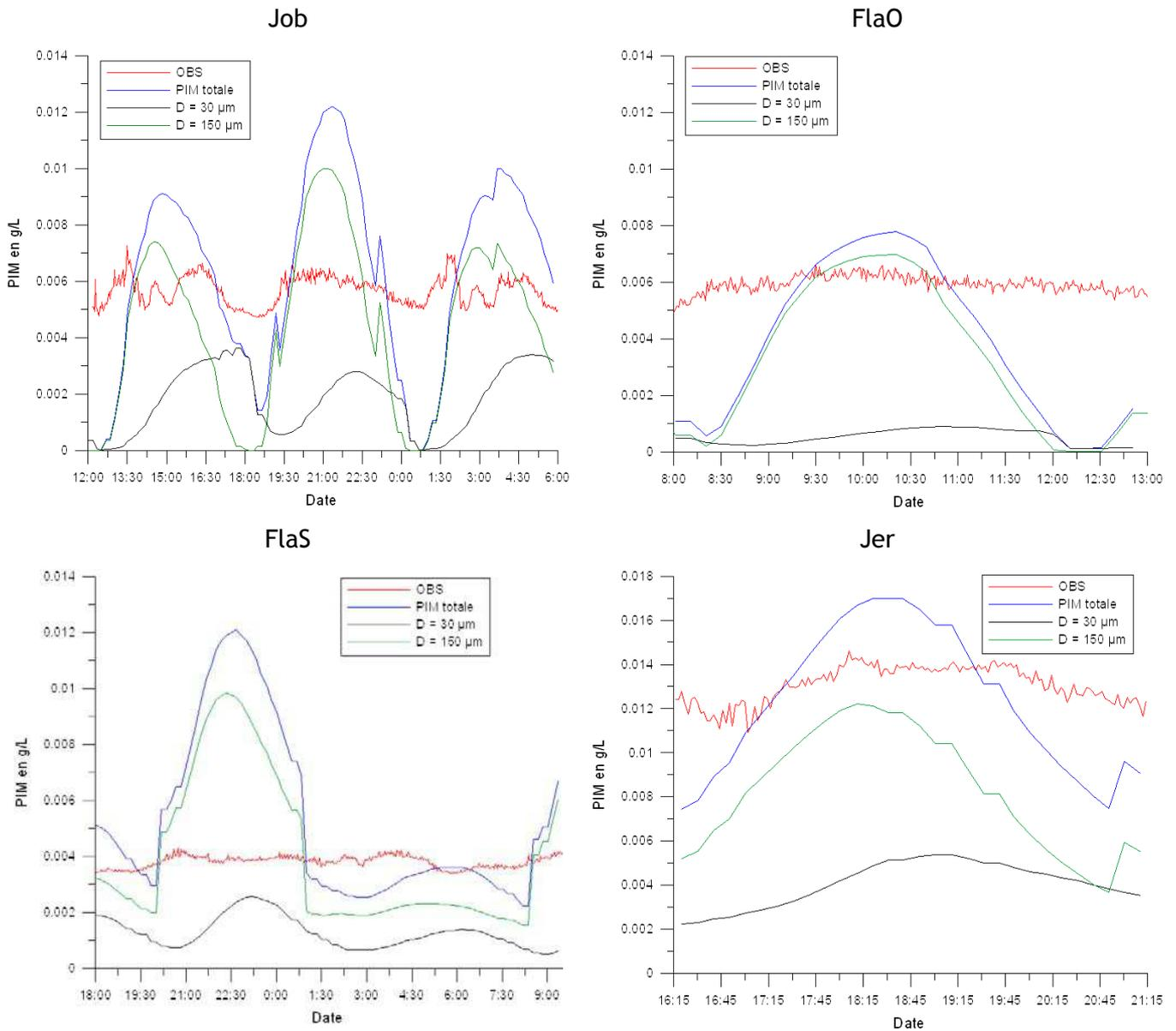
**Figure 6.22** *Matières en suspension inorganiques à 30 cm du fond : comparaison des mesures à l'OBS et des résultats du modèle avec la formulation de Cugier (2000). Contribution des différentes classes granulométriques du modèle.*
