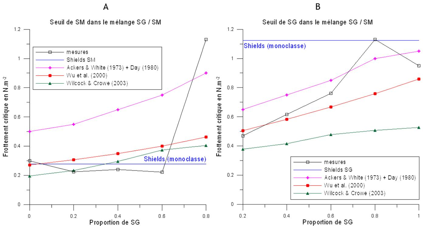
**Figure 6.24** Frottement critique des deux classes d'un mélange SG/SM : comparaison des mesures et des résultats de plusieurs formulations. A : Seuil de la classe SM. B : Seuil de la classe SG.
