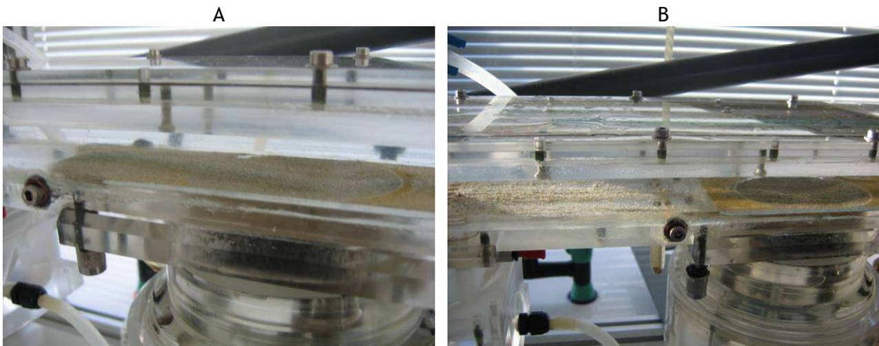
**Figure 2.9** Différents modes de transport en fonction de la granulométrie. A : Déplacement par propagation de figure sédimentaire (échantillon SF100). B : Déplacement des grains individuellement (échantillon SG40SM60).
