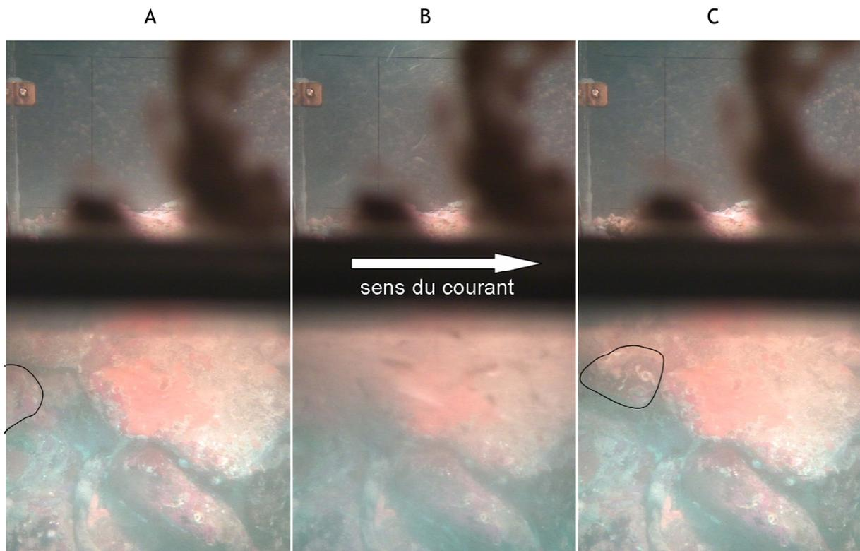
**Figure 3.34** Images acquises par le système DySPI au point Jer à 17h30 (le laps de temps entre chaque image est de  $1/25^{\text{ème}}$  de seconde). L'image en coupe est visible sur la moitié supérieure de l'image, la vue directe représente la moitié inférieure. On remarque le masquage partiel de la vue en coupe dû à un dépôt de particules.
