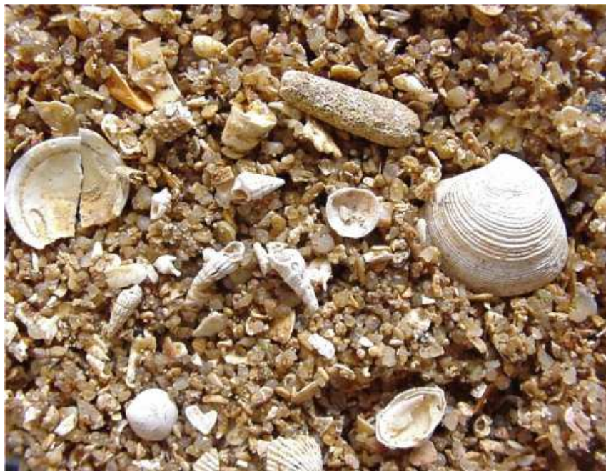
Figure 1.2 Échantillon de sédiment naturel composé de particules siliceuses et bioclastiques de diverses formes.
