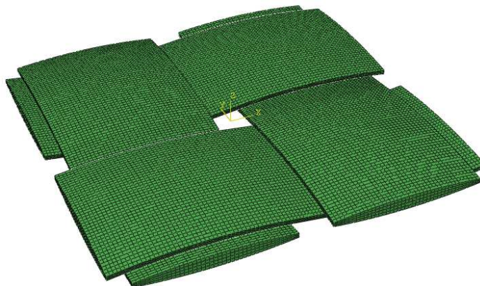
Figure 1-35. Exemple de modèle de taffetas issu du modèle de Hivet
