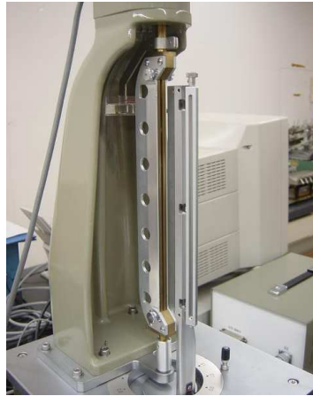
Figure 1-25. Dispositif KES-FB2 utilisé pour mesurer le comportement en flexion
