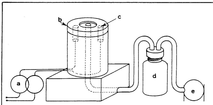
**Figure 15** : Sonde thermique utilisée pour le carottage des carottes de glace: (a) variac, (b) tête en acier inoxydable, (c) résistance chauffante, (d) flacon en polyéthylène destiné à recueillir l'eau de fusion, (e) pompe.
