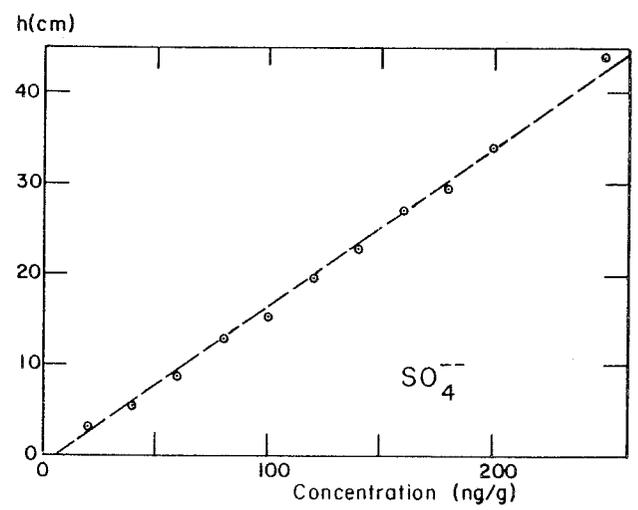
Figure 5c : Courbes d'étalonnages du nitrate et du sulfate.
