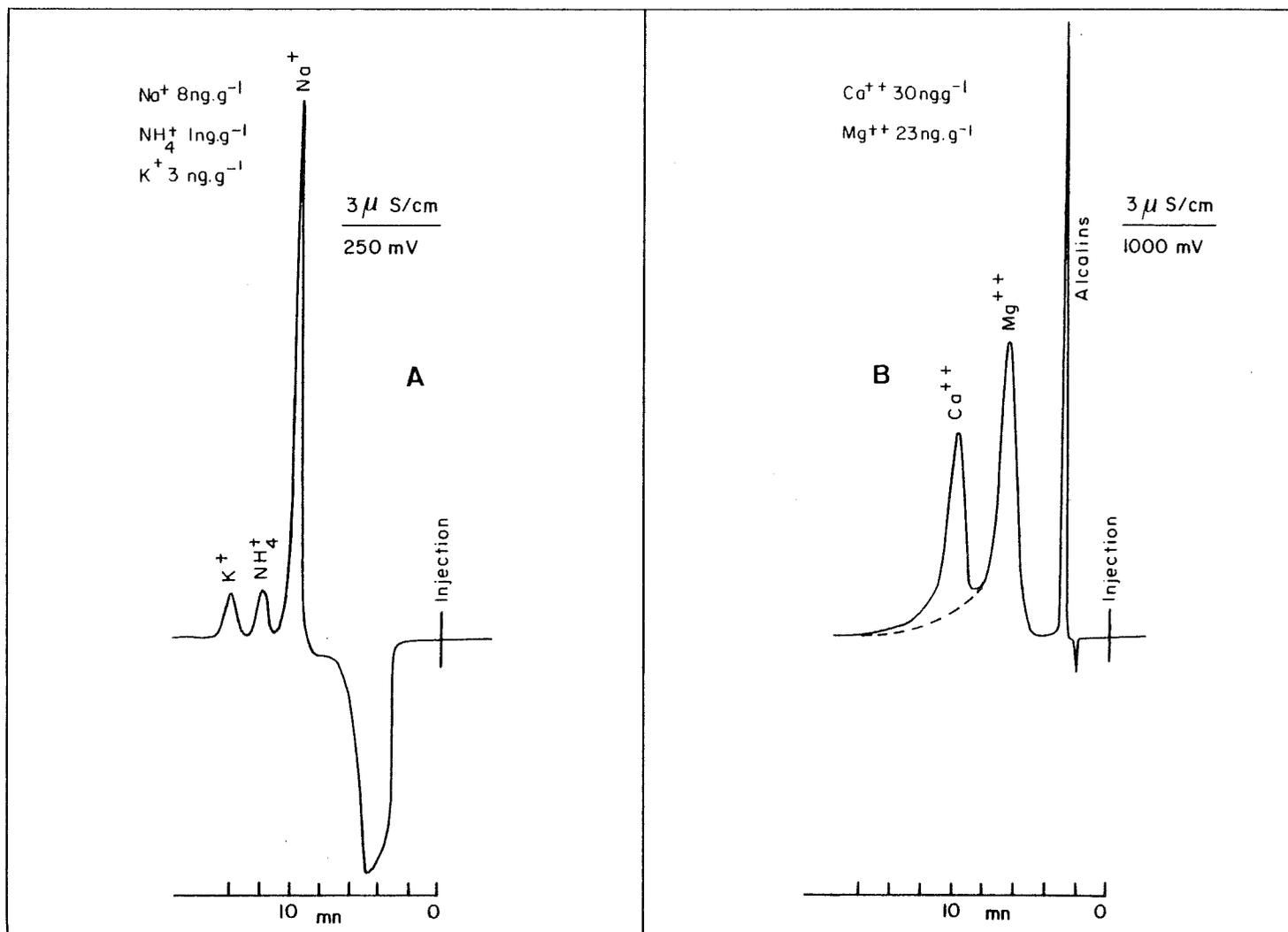
Figure 4a : Chromatogrammes obtenus pour les cations monovalents (A), pour les cations divalents (B)
