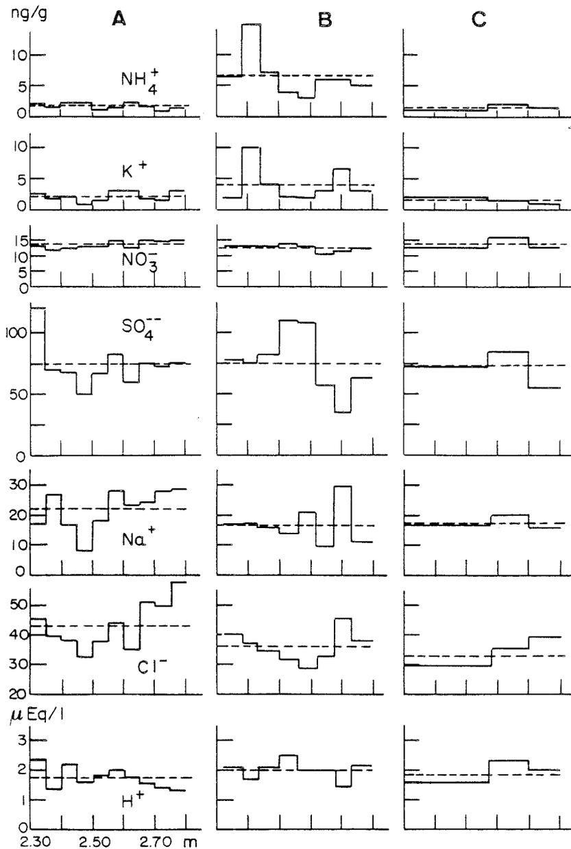
**Figure 12 :** Comparaison de trois types de prélèvements effectués sur les couches de neige déposées entre 2,30 et 2,80 mètres de profondeur au Dôme C :
