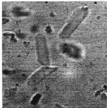
FIGURE 3.1 – Photographie sous microscope ( 100\ \mu\text{m} \times 100\ \mu\text{m} ) d'une solution concentrée de Kalliroscope, possédant une large distribution de tailles (Gauthier et al. , 1998).
