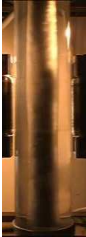
FIGURE 16.4 – Forme de l'interface photographiée à la fin d'une expérience, dans le cas où l'instabilité elliptique n'était pas présente ( \Omega = 200 \text{ trs/min} et T_i = -10^\circ\text{C} ).
