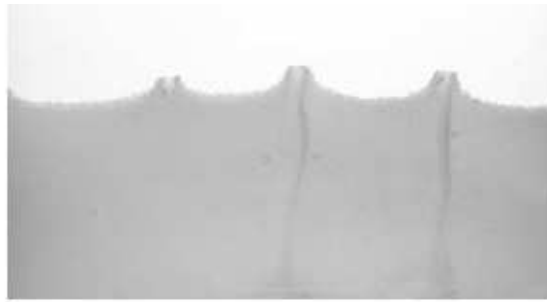
FIGURE 2.4 – Développement des cheminées en zone dendritique dans une cellule de Hele-Shaw, vue en coupe (Deguen, 2009).
