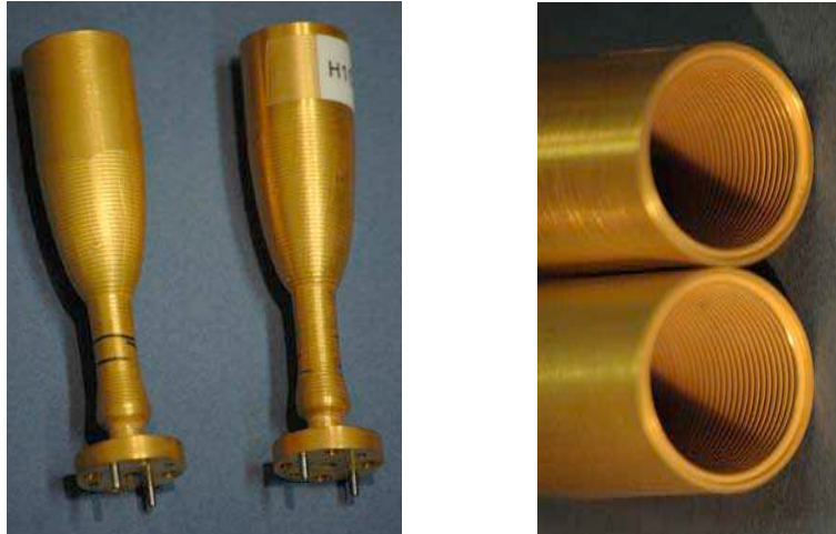
FIG. 6.3: Cornets corrugués développés pour CLOVER par nos collaborateurs de l'université de Manchester.
