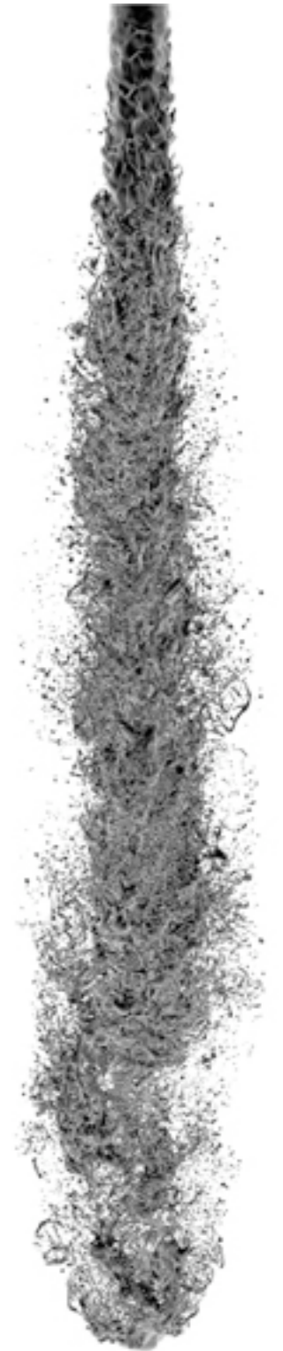
DNS de jet Diesel Thèse de T. Ménard CORIA (2007)
