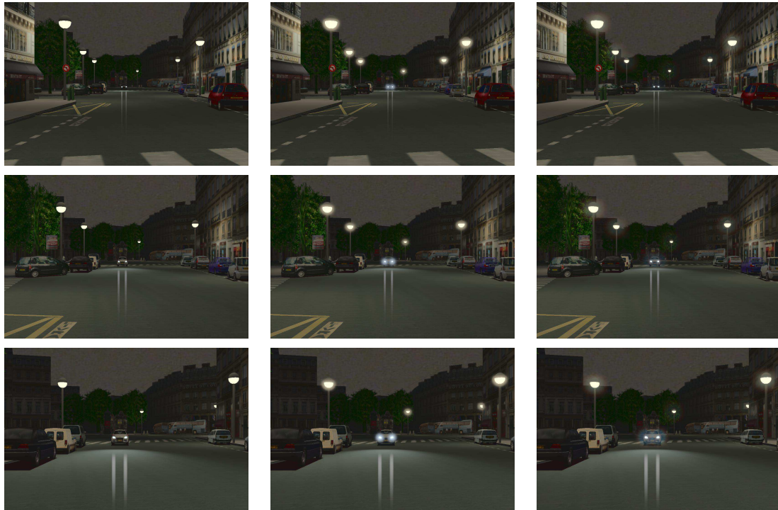
FIGURE 6.5 – Comparaison d'images HDR traitées sans simulation de l'éblouissement (à gauche), puis avec simulation de l'éblouissement de [Kawase 04] (au centre), et [Spencer 95] (à droite). Base de données INRETS-MSIS-2007.
