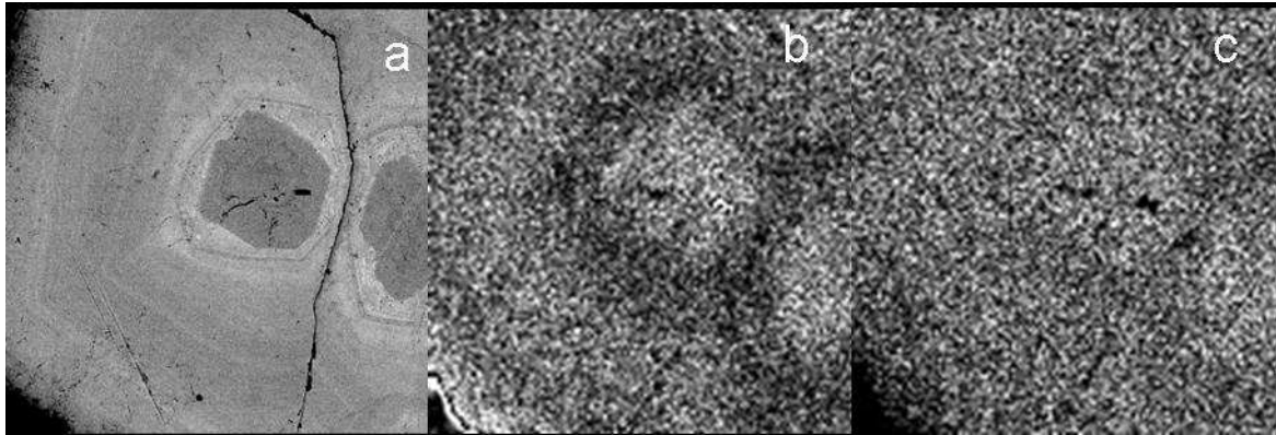
Figure 57 : Images de la surface polie de l'échantillon kazakh en MEB BSE (a) et cartographie élémentaire microsonde associée de Ca (b) et Mo (c).
