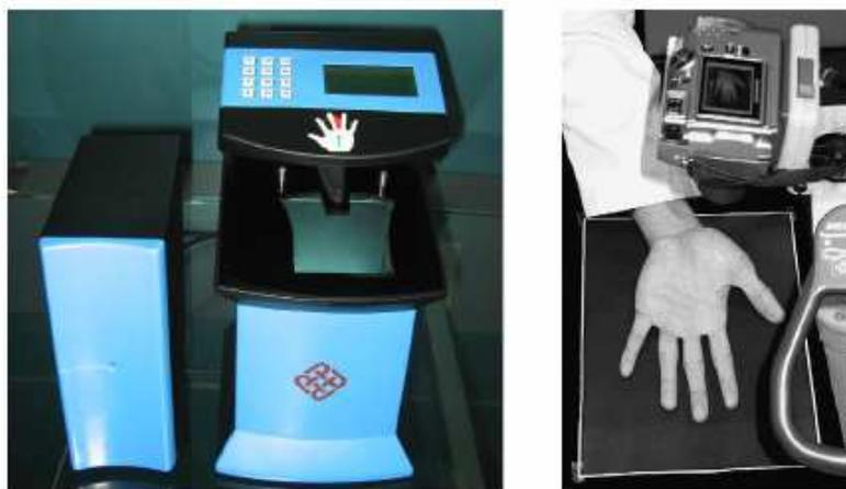
**Figure IV.2 :** Exemples de systèmes d'acquisition de la paume (figures extraites des travaux de Kong et al. [Kong09] (gauche), et Kumar et al. [Kuma06] (droite)).
