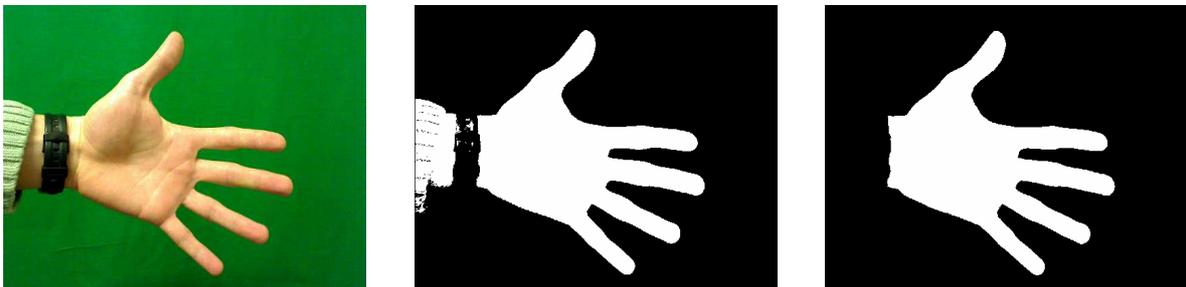
**Figure V.11 :** *Images obtenues lors de la segmentation : image d'origine (gauche), image après le seuillage (au milieu) et image finale après l'érosion et la suppression de débris.*
