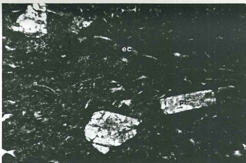
Phénocristaux de plagioclase (pl) trapus et allongés dans une matrice riche en écharde (ec) orientées, lumière normale.
