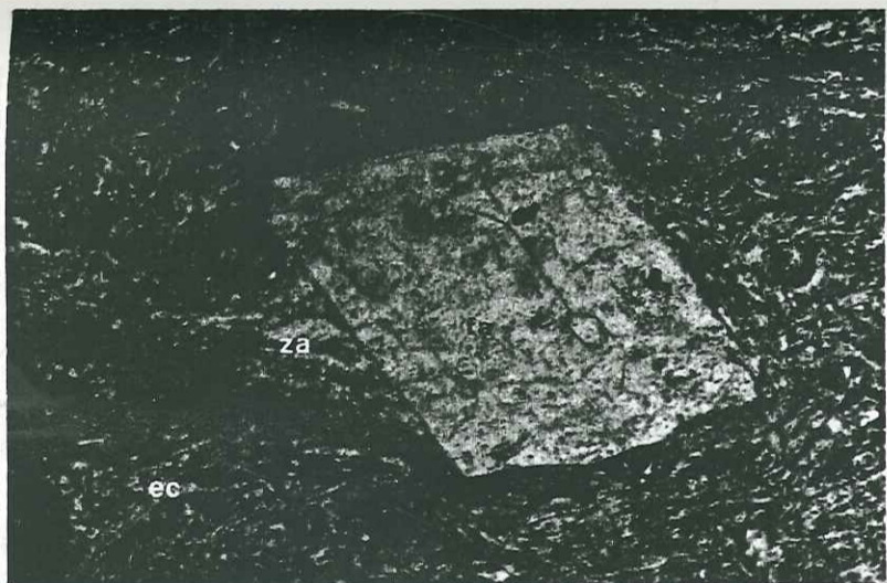
Phénocrystal de feldspath potassique (fa) dont le grand axe est orienté dans la direction de la pseudo-fluidalité, les zones abritées (za) indiquent un sens relatif d'écoulement dans l'ignimbrite riche en écharde (ec), lumière normale.
