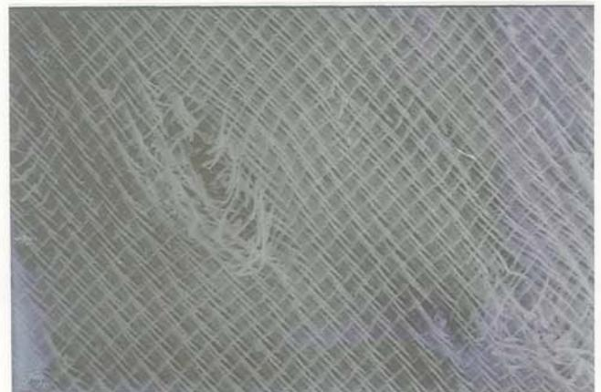
Fig. E35 : Déchirure du géotextile tX lors d'un essai de frottement (sens diagonal). Sol de couverture et sol support : Gravette Concassée. Contrainte normale :  $\sigma_N = 75 \text{ kPa}$
