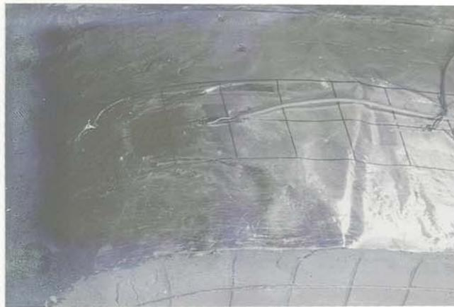
Fig F84 : Rupture de la nappe d'aluminium de fort module et de faible effort de traction à la rupture
