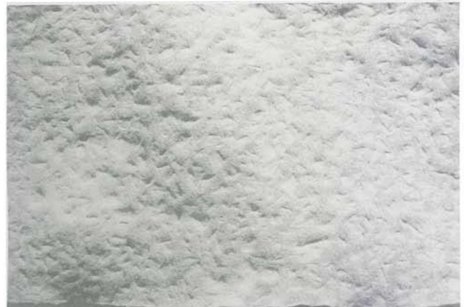
Fig. D12 : Colmatage en régime d'écoulement permanent Géotextile BD 300 côté drain (Drain de pied du barrage de Valcros) Prélèvement après 7 ans de fonctionnement
