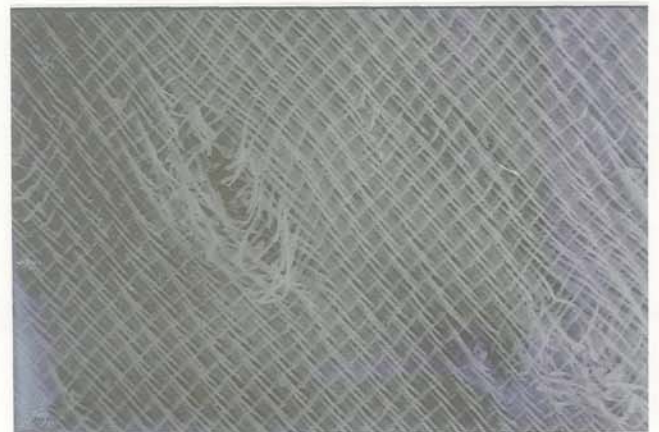
Fig. E35 : Déchirure du géotextile TX lors d'un essai de frottement (sens diagonal). Sol de couverture et sol support : Gravette Concassée. Contrainte normale : \sigma_N = 75 \text{ kPa}
