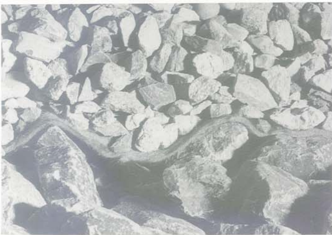
Mise en évidence de la souplesse du géotextile (entre ballast et gravette concassée)
