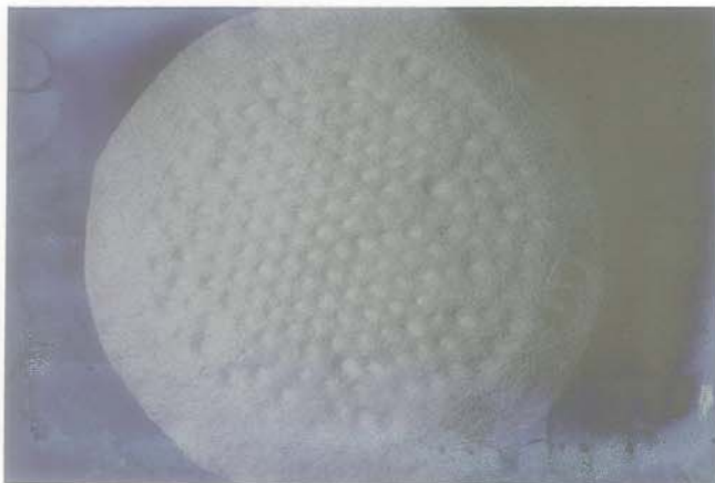
Fig. D11 : Colmatage dynamique (appareillage L185 - IRIGM-ITF) BD 280 en fin de chargement : à droite côté sol, à gauche côté drain
