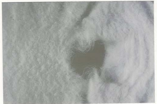
Fig. E34 : Déchirure du géotextile BD 340 lors d'un essai de frottement. Sol de couverture et sol support : Ballast. Contrainte normale : \sigma_N = 50 \text{ kPa}
