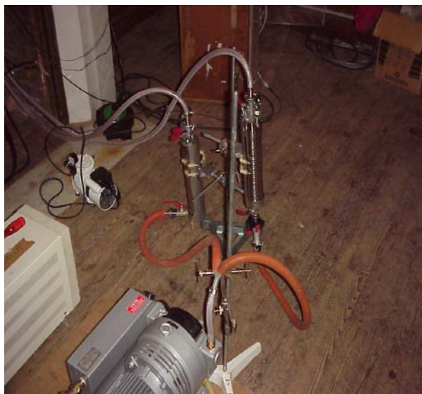
Figure 1.2.3: Vue du montage expérimental pour l'échantillonnage des aérosols en aval du WAI à l'aide d'impacteurs en cascade
