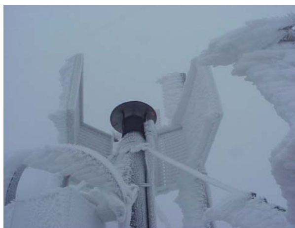
Figures 1.2.2: (a) Vue du WAI avec le dégivrage en fonctionnement et les grilles destinées à l'abaissement de la vitesse horizontale du vent (b) Séparateur de flux en sortie du WAI
