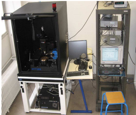
FIGURE 3.16: Le système de mesure Agilent B1505 avec la station sous pointes semi-automatique.
