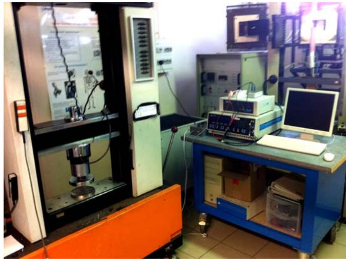
*Figure A-9* : La machine de compression INSTRON 1195 et l'impédance-mètre de Solartron se joignent pour la mesure in situ des propriétés électriques et diélectriques sous la compression mécanique.
