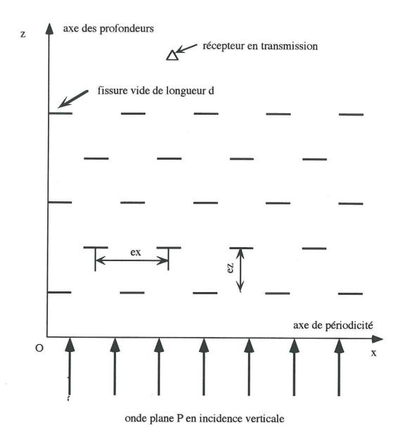
**Figure IV.2**: Distribution régulière de 23 fissures vides, horizontales et à faces parallèles. Définition des paramètres "ex" et "ez" qui représentent respectivement la distance de séparation de deux centres de fissures adjacentes sur une même ligne horizontale et la distance de séparation verticale entre deux lignes horizontales adjacentes de fissures.
