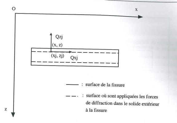
Figure B1 : Surface d'application des forces de diffraction dans le solide extérieur à la fissure.
