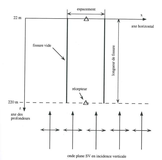
**Figure V.9**: Configuration des fissures verticales et des récepteurs, dans les simulations numériques où nous ne faisons intervenir que 2 fissures. L'épaisseur des fissures est infime, soit de 0.01 m. Le champ excitateur est une onde plane SV en incidence verticale sur le milieu fissuré.
