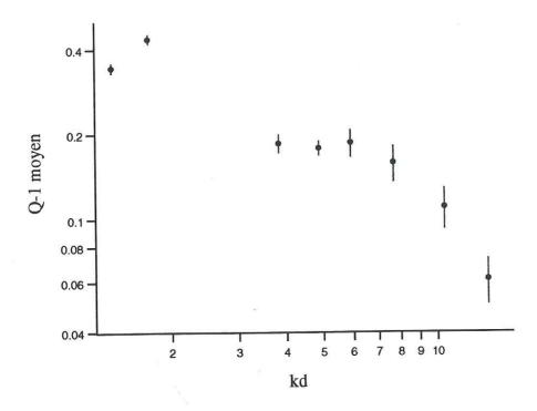
**Figure IV.11**: Facteur d'atténuation moyenné sur 30 traces centrales (voir figure IV.10) en fonction du paramètre k\*d où d=100 m. La barre en chaque point correspond aux déviations standards. 1/Q atteint son maximum pour k\*d=2.
