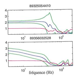
Figure V.30: Même chose que la figure V.29, excepté qu'il s'agit ici d'enregistrements sur la composante Est-Ouest des stations à 220 m et 22 m de profondeur. Seuls 4 évènements ont été sélectionnés.
