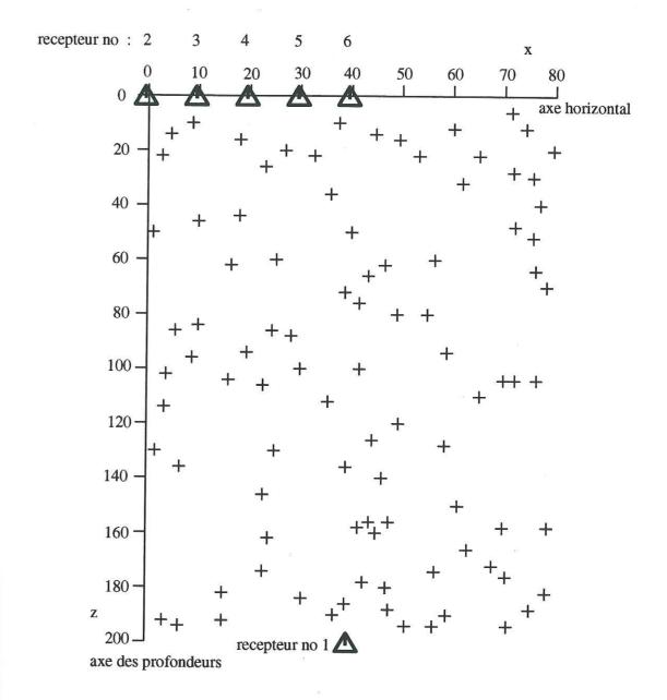
Figure V.15: Distribution aléatoire de centres de fissures (croix), 94 fissures verticales (selon l'axe des profondeurs), de 10 m de long et de 0.01 m d'épaisseur. Les triangles représentent 6 récepteurs. Nous n'avons pas introduit de surface libre dans notre modèle de milieu fissuré, ni dans les modèles suivants.
