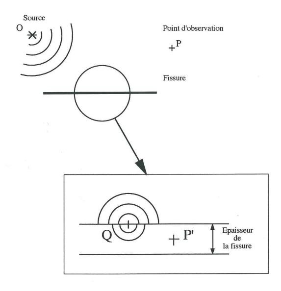
Figure II.2: Schéma de la méthode. Le point P désigne un point d'observation en dehors de la fissure, tandis que le point P' correspond à un point d'observation situé à l'intérieur de la fissure supposée ouverte. Le point Q représente un point sur l'une des faces de la fissure, ce point joue le rôle de source secondaire et réemet de l'énergie lorsque la fissure est sollicitée par un champ d'onde extérieur provenant d'une source sismique symbolisée par le point O.
