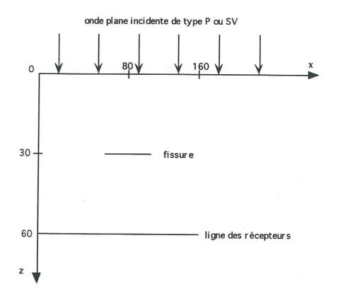
Figure III.3: Configuration source-fissure-récepteurs.
