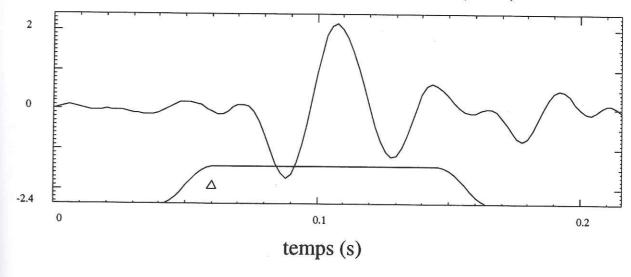
Figure V.28: Accélérogrammes sur la composante Nord-Sud, au niveau du début de l'arrivée des ondes S à la station à 220 m de profondeur et à la station à 22 m de profondeur pour l'évènement "90087231128". Pour ces deux enregistrements, la fenêtre d'apodisation (soit 64 points en temps) a également été représentée pour montrer comment le pointé des ondes S a été réalisé. Pour ce séisme en particulier, ces signaux montrent une bonne cohérence.
