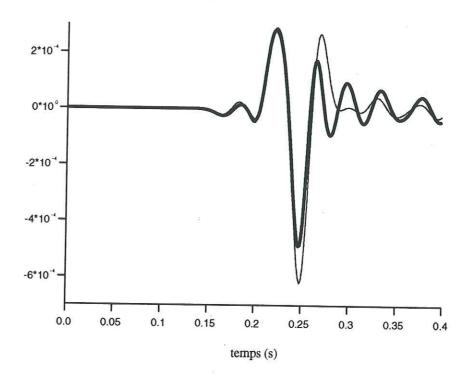
Figure V.14: Déplacement total, en mètres, à 22 m de profondeur et pour une fréquence centrale de Ricker de 20 Hz. Trait épais: 2 fissures vides, de 198 m de long et espacées de 100m (voir figure V.9). Trait fin: 2 fissures remplies d'un fluide non visqueux, de 198 m de long et espacées de 100 m. Dans les deux cas, les fissures ont une épaisseur de 0.01 m.
