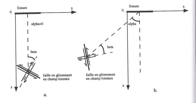
**Figure VI.6**: Configuration source-fissure. La source est une faille en glissement en champ lointain par rapport à une fissure remplie d'un fluide non visqueux. L'angle alpha varie de 0 à 90° alors que l'angle bêta est maintenu fixe. **a.**: cas alpha=0° et **b.**: cas alpha=50°.
