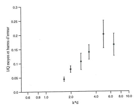
**Figure V.26**: Facteur d'atténuation moyenné sur 31 traces centrales, enregistrées en transmision, dans le cas des 18 fissures horizontales, de longueur d=40 m (voir figure V.25.a).
