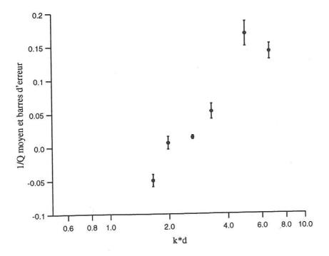
**Figure V.27**: Facteur d'atténuation moyenné sur 31 traces centrales, enregistrées en transmision, dans le cas des 18 fissures horizontales, de longueur d=40 m et régulièrement espacées les unes des autres (voir figure V.25.b).
