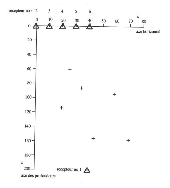
**Figure V.17**: Distribution aléatoire de centres de fissures (croix), 6 fissures verticales (selon l'axe des profondeurs), de 40 m de long et de 0.01 m d'épaisseur. Les triangles représentent 6 récepteurs.
