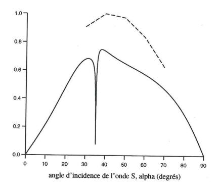
Figure VI.8: Module du coefficient de transmission d'une ondes S incidente sur une interface solide/fluide et qui se convertie en une onde P dans le fluide (courbe en trait plein). Ce coefficient de transmission présente une singularité vers 35° qui correspond à l'angle critique pour lequel l'onde S se réfléchie en une onde P qui se propage le long de l'interface solide/fluide du côté du solide. En pointillés, variations du maximum absolu des ondes S de pression (valeurs tirées du tableau VI.1).
