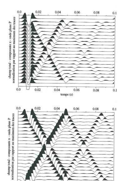
**Figure III.9**: Déplacements sur l'une des faces d'une fissure elliptique, horizontale, vide, pour une onde plane P en incidence verticale. Sont représentées, avec une normalisation par rapport au maximum des traces, la composante z du champ total (figure du haut) et la composante x du champ total (figure du bas).
