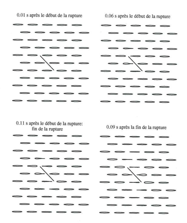
Figure VI.2: Instantanés de l'état de déformation des fissures à quatre différents temps de propagation des ondes. L'ouverture des fissures a été exagérée selon la verticale d'un facteur 10 et il se rajoute encore à cette exagération les déformations des fissures qui sont multipliées par un facteur 15.
