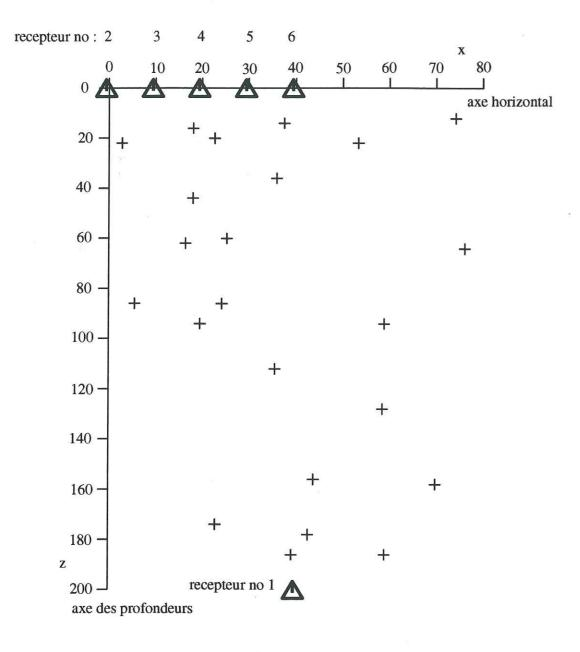
**Figure V.16**: Distribution aléatoire de centres de fissures (croix), 23 fissures verticales (selon l'axe des profondeurs), de 20 m de long et de 0.01 m d'épaisseur. Les triangles représentent 6 récepteurs.
