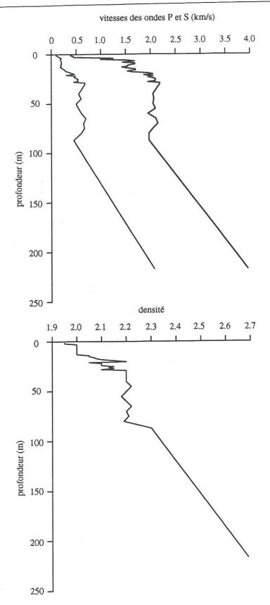
**Figure V.4**: Modèles de vitesse et de densité en fonction de la profondeur, sur le site de Garner Valley, suite à des mesures récentes réalisées par l'IPSN (Cotton, 1997).
