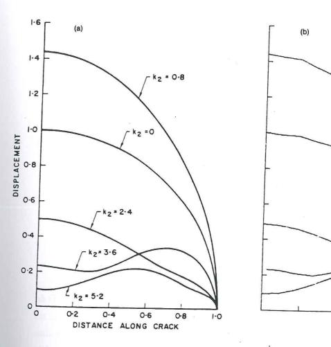
Figure II.1: (a) Amplitude du déplacement sur une face d'un crack de Griffith calculée par Mal (1970) dans le cas d'une onde plane P en incidence verticale, pour différentes fréquences excitatrices. Les résultats sont normalisés par rapport au déplacement statique au centre de la fissure. k2 représente le nombre d'onde des ondes S. (b) Même chose que (a) mais calculé avec la méthode décrite dans ce chapitre (d'après Bouchon, 1987).
