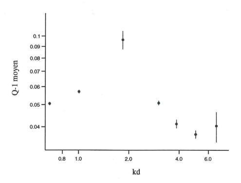
**Figure IV.13**: Cette figure est l'équivalent de la figure IV.11 excepté qu'il s'agit ici de l'étude de l'atténuation par la zone fracturée contenant 234 fissures vides de longueur d=80 m. Le facteur d'atténuation a été moyenné sur 31 traces centrales (voir figure IV.12); 1/Q est représenté en fonction du paramètre k\*d. La barre en chaque point correspond aux déviations standards. 1/Q atteint son maximum pour k\*d=2.
