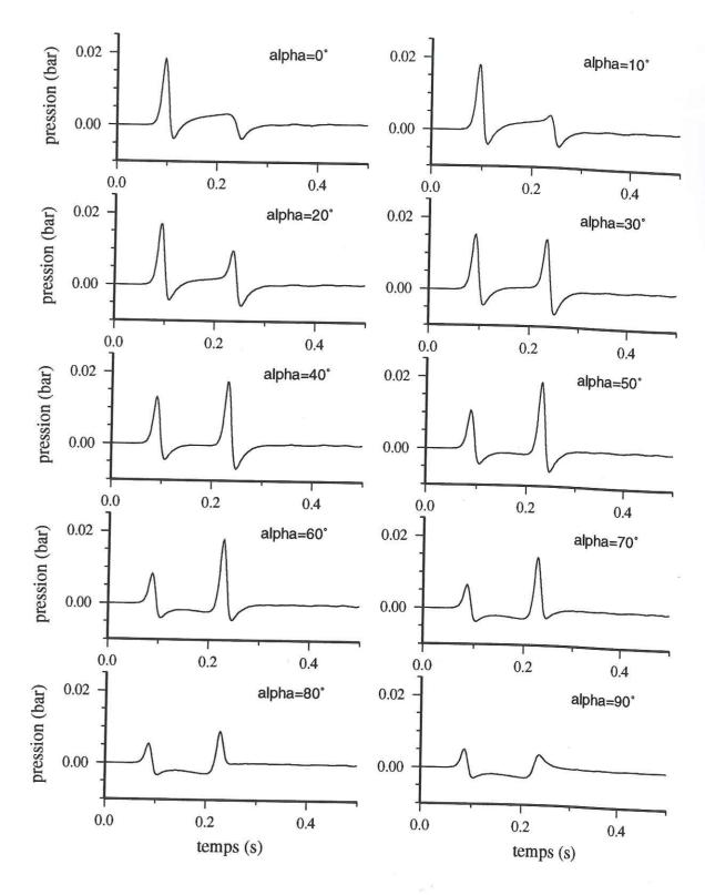
Figure VI.7: Enregistrements synthétiques de la pression du fluide dans la fissure en fonction du temps, pour différents angles d'incidence (angle alpha sur la figure VI.3). Le premier pic correspond aux ondes P, le second pic aux ondes S. Le signal des ondes P diminue quand l'angle d'incidence, alpha, augmente alors que le signal des ondes S atteint un maximum d'amplitude vers 40°.
