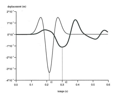
Figure IV.15: Déplacement incident (trait fin) et déplacement total (trait épais) pour un récepteur en transmission dans le cas de 23 fissures vides de longueur d=100 m. La fréquence centrale du Ricker est fixée à 7 Hz. L'onde transmise est retardée de façon notable lorsque l'on se place aux grandes longueurs d'onde (cf théorie de Hudson).
