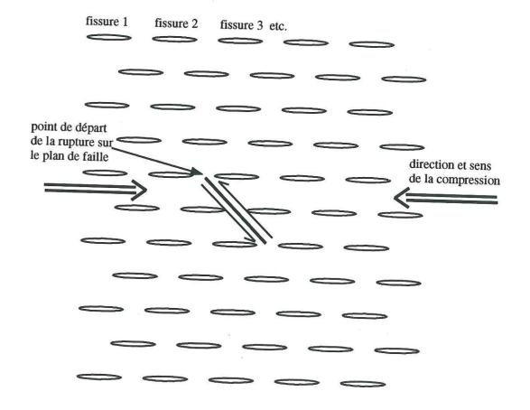
FigureVI.1: Modèle d'une zone de faille. Les fissures sont elliptiques et remplies d'un fluide non visqueux. Les flèches de part et d'autre du plan de faille indiquent le sens du glissement. Le point où débute la rupture correspond à l'extrémité supérieure du plan de faille.
