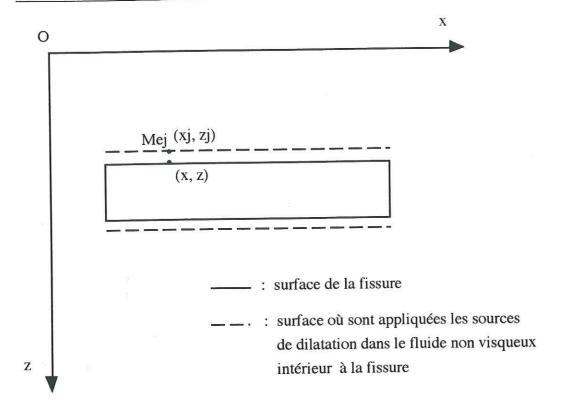
Figure B2: Surface d'application des sources de dilatation dans le fluide non visqueux intérieur à la fissure.
