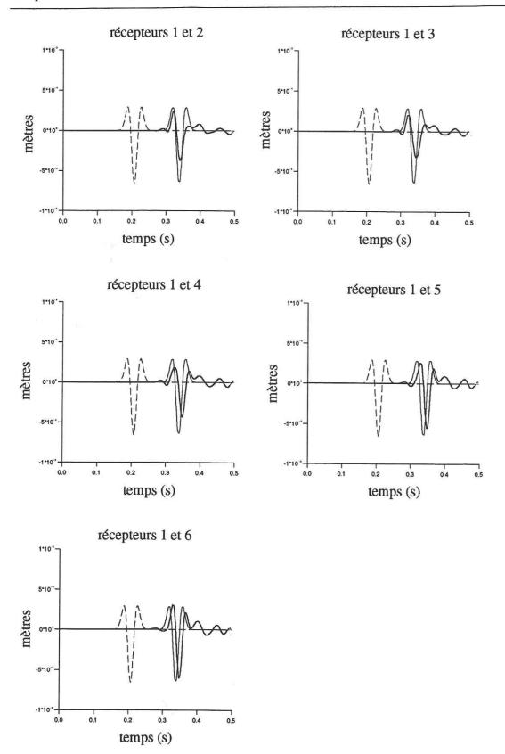
Figure V.20: Sismogrammes synthétiques au niveau des 6 récepteurs pour le milieu contenant 6 fissures de 40 m de long (voir figure V.17).
