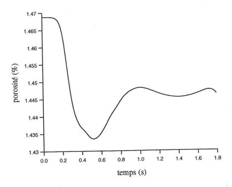
Figure VI.5: Variations temporelles de la porosité de la zone de faille pendant et après le glissement sur le plan de faille. La porosité continue de diminuer après la fin du glissement pour augmenter légèrement avant d'atteindre sa valeur finale.
