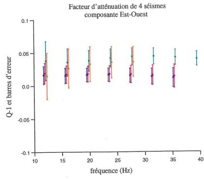
Figure V.31: Facteur d'atténuation et barres d'erreur, à certaines fréquences, pour la composante Nord-Sud entre 220 et 22 m de profondeur, pour 7 séismes sélectionnés (figure du haut). Facteur d'atténuation et barres d'erreur, à certaines fréquences, pour la composante Est-Ouest entre 220 et 22 m de profondeur, pour 4 séismes sélectionnés (figure du bas).
