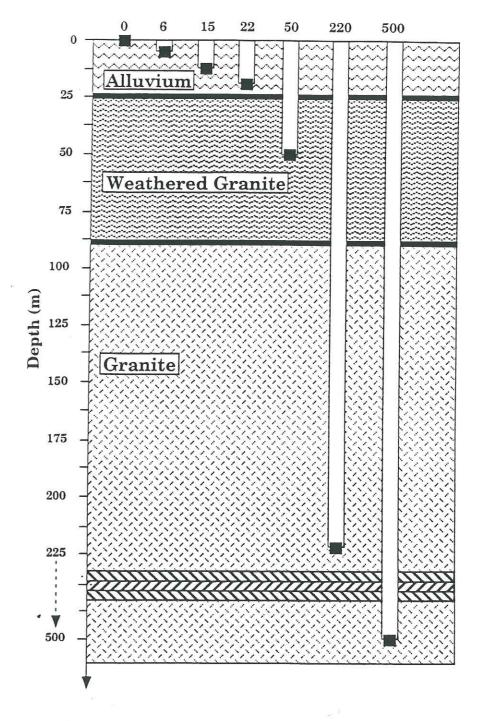
Figure V.5: Réseau des 7 stations sismologiques à différentes profondeurs du réseau GVDA et géologie du site (tiré du rapport intitulé: "Enregistrements accélérométriques et mesures de pression hydraulique dans un forage profond (520 m) sur le site de Garner Valley. Phase I: Mise en place de l'expérimentation", Institute for Crustal Studies, University of California, Santa Barbara, printemps 1996).
