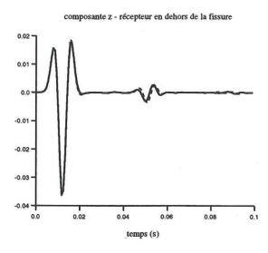
**Figure III.1**: Composantes horizontale et verticale du déplacement total (somme du déplacement incident et du déplacement diffracté) en un point extérieur à une fissure elliptique, horizontale (trait épais) et à une fissure à faces parallèles, horizontale (trait en pointillés), soumises toutes deux à une onde plane P en incidence verticale. Les différences entre les deux cas sont très faibles, surtout sur la composante verticale.
