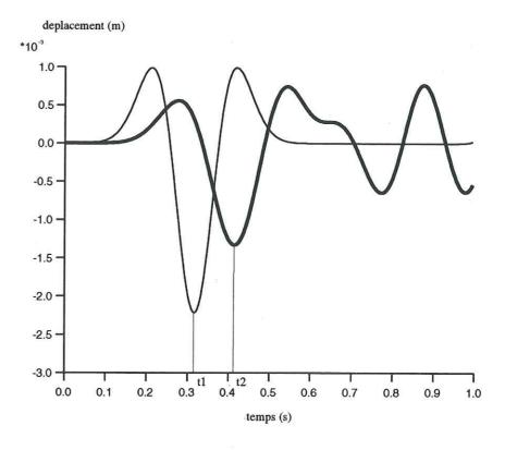
Figure IV.16: Déplacement incident (trait fin) et déplacement total (trait épais) pour un récepteur en transmission dans le cas de 234 fissures vides de longueur d=80 m. La fréquence centrale du Ricker est fixée à 3,75 Hz. L'onde transmise est, là encore, retardée de façon notable.
