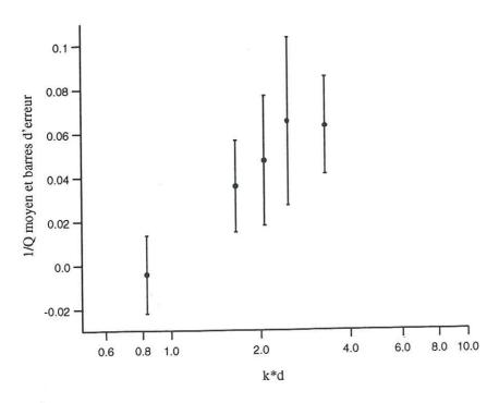
**Figure V.23**: Facteur d'atténuation moyenné sur 49 traces centrales, enregistrées en transmision, dans le cas des 69 fissures de longueur d=20 m (voir figure V.22.a).
