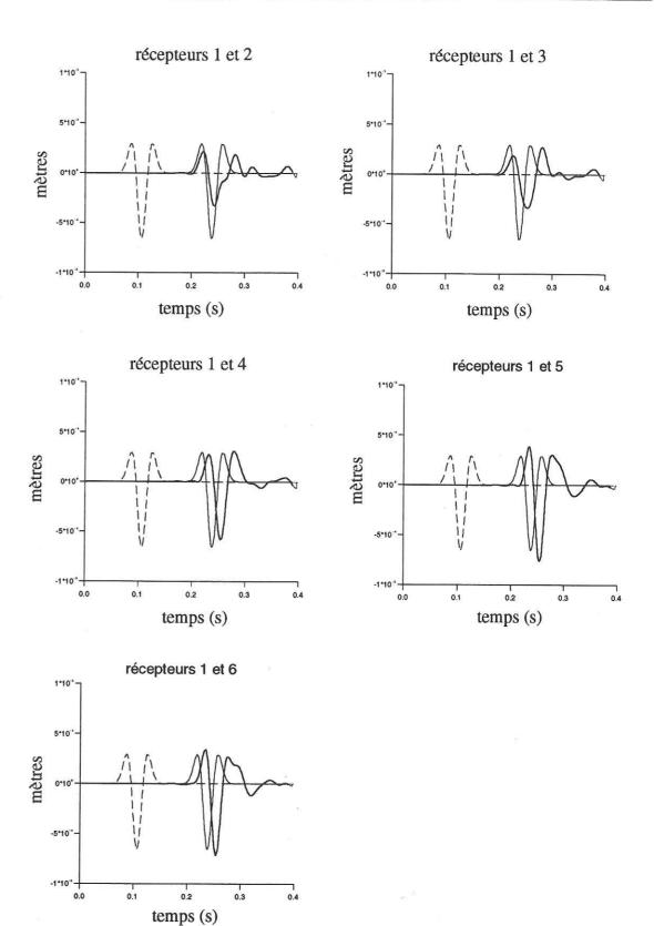
Figure V.19: Sismogrammes synthétiques au niveau des 6 récepteurs pour le milieu contenant 23 fissures de 20 m de long (voir figure V.16).
