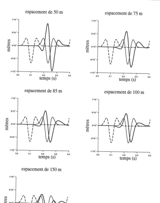
**Figure V.11**: Sismogrammes synthétiques avec une fréquence centrale du Ricker de 10 Hz pour 2 fissures vides (voir figure V.9) dont on a fait varier l'espacement de 50 à 150 m. La mesure du taux d'anisotropie est expliquée dans la figure V.10.
