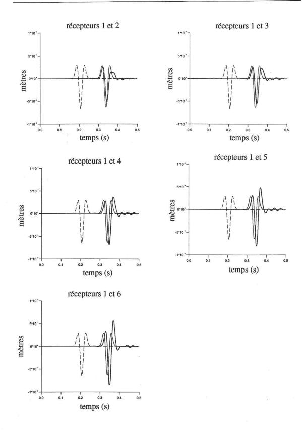
Figure V.18: Sismogrammes synthétiques au niveau des 6 récepteurs pour le milieu contenant 94 fissures de 10 m de long (voir figure V.15). La fréquence centrale du Ricker est de 20 Hz ainsi que dans les deux figures suivantes.
