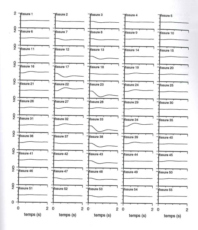
Figure VI.4: Variations temporelles de la surface de chacune des 55 fissures considérées. Les surfaces ont toutes été normalisées par rapport à la surface initiale, identique pour toutes les fissures. Il est facile de constater une antisymétrie par rapport au plan de faille pour lequel le sens du glissement détermine les quadrants de compression-dilatation.
