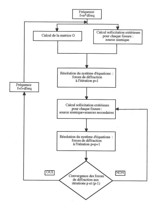
**Figure IV.1**: Organigramme de la méthode itérative qui permet de calculer le champ de déplacement diffracté pour un grand nombre de fissures.
