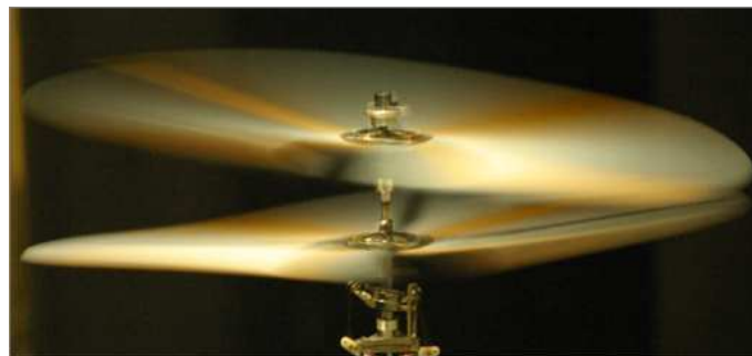
FIGURE 3.9 – Torsions des pales avec un vent latéral important et une incidence du plateau cyclique non nulle.
