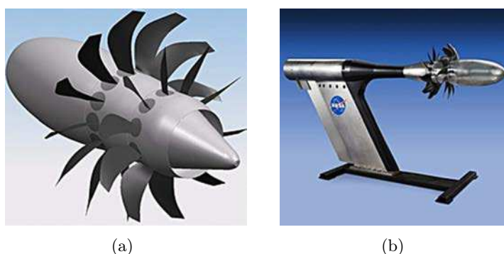
FIGURE 1.12 – (a) Soufflante non-carénée - (b) Prototype de soufflante non-carénée sur une balance aérodynamique.
