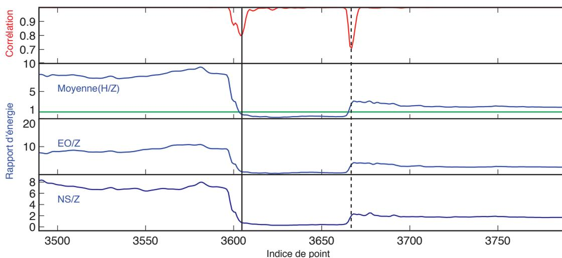
FIGURE A.3 – Identification d'onde P et S
