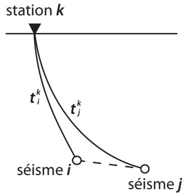
FIGURE 7.1 – Illustration du principe de double différence.
