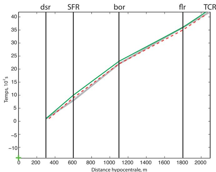
FIGURE A.5 – Extrapolation de l'origine d'un séisme mineur
