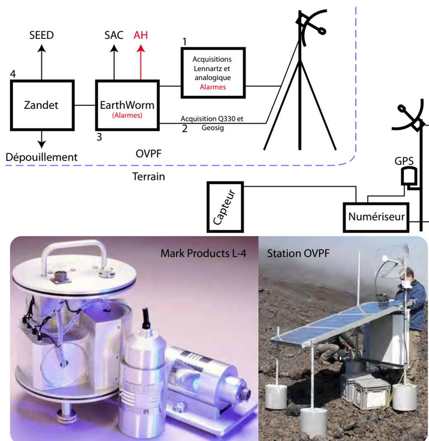
FIGURE 5.2 – Schéma de l'acquisition sismique
