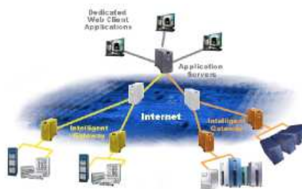
FIG. 7.1 – Exploitation des passerelles à distance
