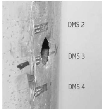
**FIGURE 3.13:** Faciès de rupture du cylindre vide [TIM 03].
