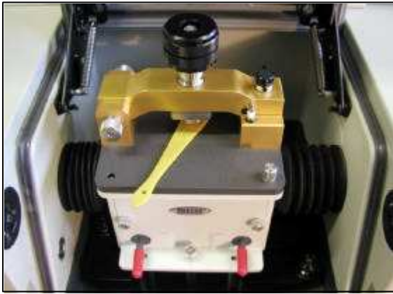
Figure 7a : Branche d'éventail positionnée sur le cristal de diamant, maintenue par l'enclume.
