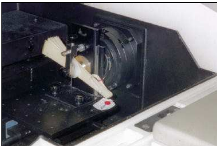
Figure 3 : Eventail positionné dans le compartiment d'analyse du spectromètre PE 2000.
