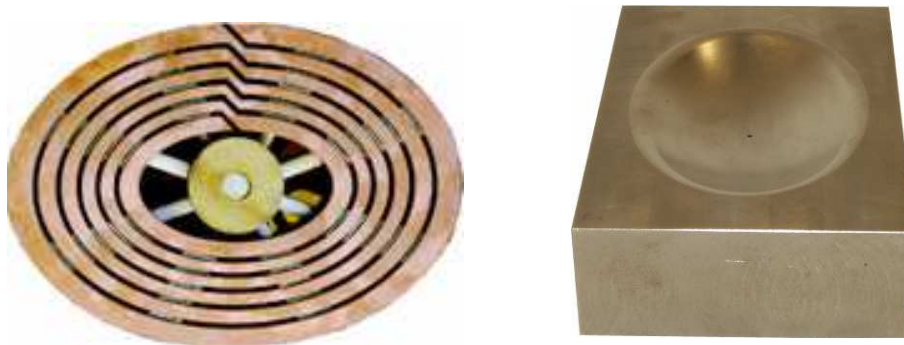
Figure I.9 Images de la matrice et de l'inducteur dans le cadre d'une application industrielle
