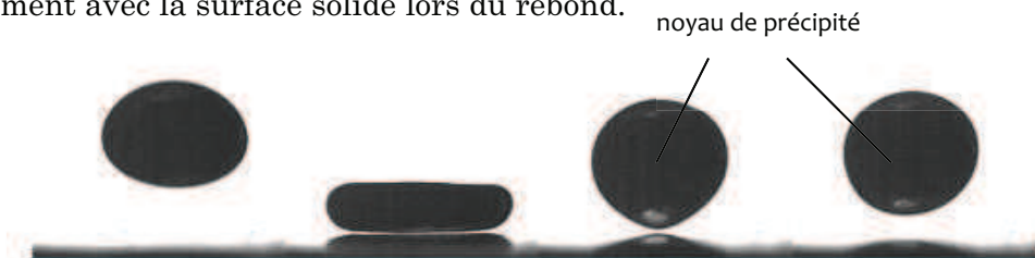
Figure 11 - Illustration du confinement du noyau de précipité au centre des gouttes lors du rebond d'une goutte de 5 mm de diamètre chargée de précipités
