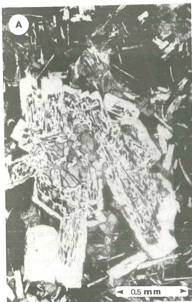
FIG 79 - Plagioclase renfermant des inclusions de phase vitreuse.
