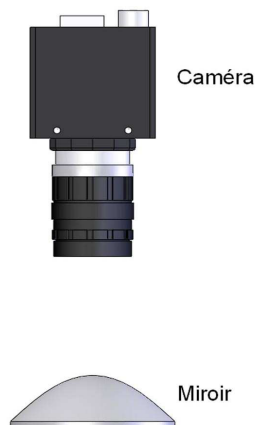
Figure 36: Exemple de capteur catadioptrique.
