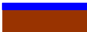
1. Dépôt sur Silicium de l'aluminium de 100\text{nm} pour gravure DRIE à 5\mu\text{m}
