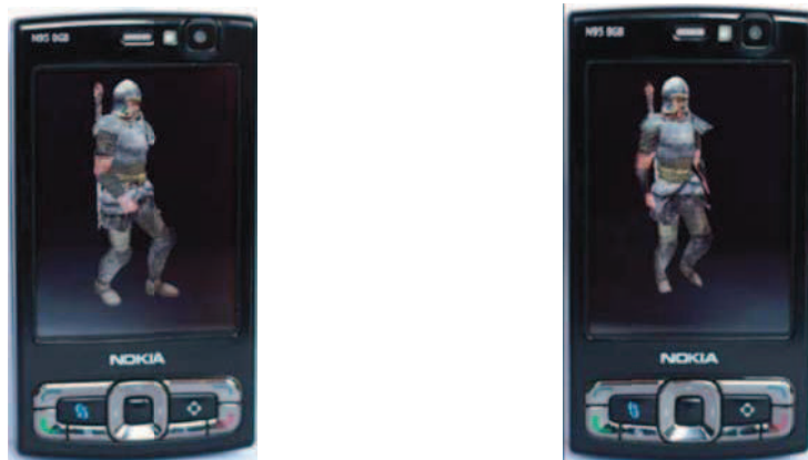
a) Modèle original, 6846 triangles, b) Modèle simplifié, 1874 triangles, fréquence : 32fps
