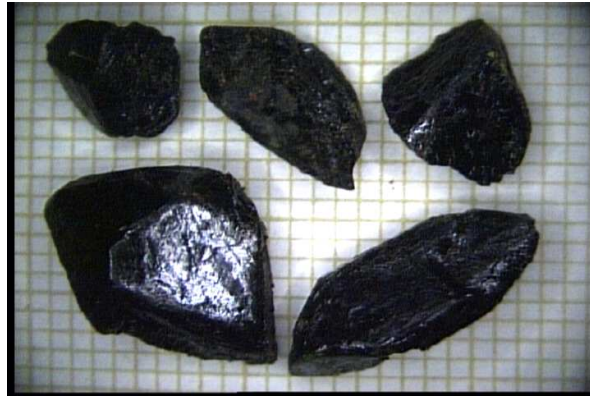
Fig. 3.8 – Mono-cristaux de DMA-CuCl 3 synthétisés au Japon par Y. Inagaki.
