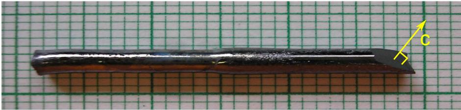
**Fig. 4.5** – Cristal de  $\text{BaCo}_2\text{V}_2\text{O}_8$  obtenu par P. Lejay [73] par fusion de zone à l'Institut Néel, Grenoble. L'axe  $c$  des chaînes est orienté à environ  $45^\circ$  de l'axe de croissance
