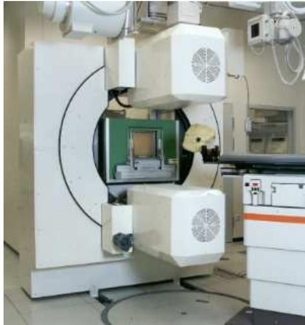
figure I-33 : Dispositif de détection TEP en ligne développé en sortie du faisceau thérapeutique au GSI[97]
