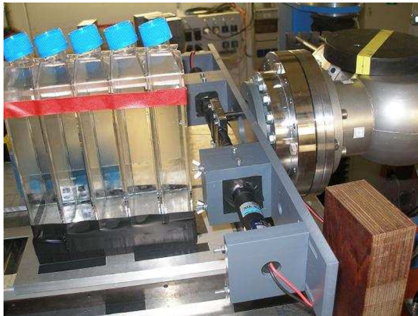
figure III-3 Cible d'eau (5 bouteilles à gauche sur l'image) positionnée devant la sortie du tube à vide (à droite). Entre la cible et la sortie du faisceau se trouvent deux scintillateurs plastiques de 1 mm d'épaisseur (ST1 et ST2) servant à l'étiquetage temporel des ions incidents.
