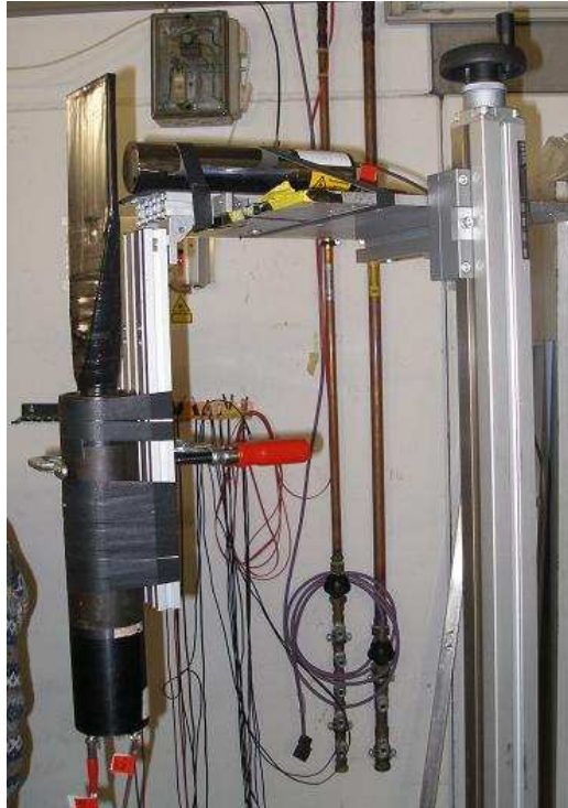
figure III-4 : le télescope de détection de fragments chargés placé dans le plan horizontal du faisceau et constitué de deux scintillateurs. Le premier (vertical à gauche) est un scintillateur plastique et le deuxième (tube métallique horizontal) est un scintillateur inorganique NaI(Tl).
