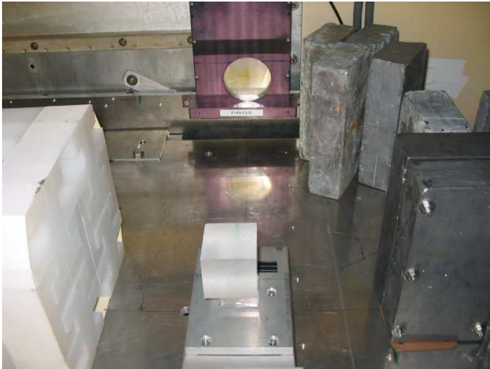
figure III-7 : cible de PMMA (5x5x5 cm) en cours de positionnement devant la sortie du faisceau (disque argenté de la fenêtre du profileur à gaz en haut de l'image)
