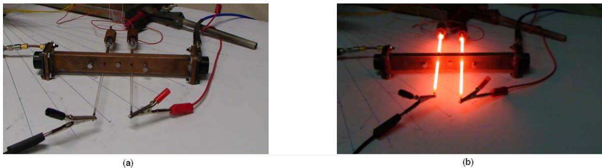
Figure IV.4: Visualisation de la structure périodique dans un guide d’onde WR90 étudiée : (a) tubes plasmas éteints ; (b) tubes plasmas allumés
