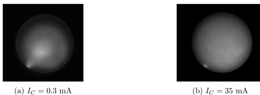
Figure II.23: Images CCD à différents courants dans l'Ar à 4 Torr
