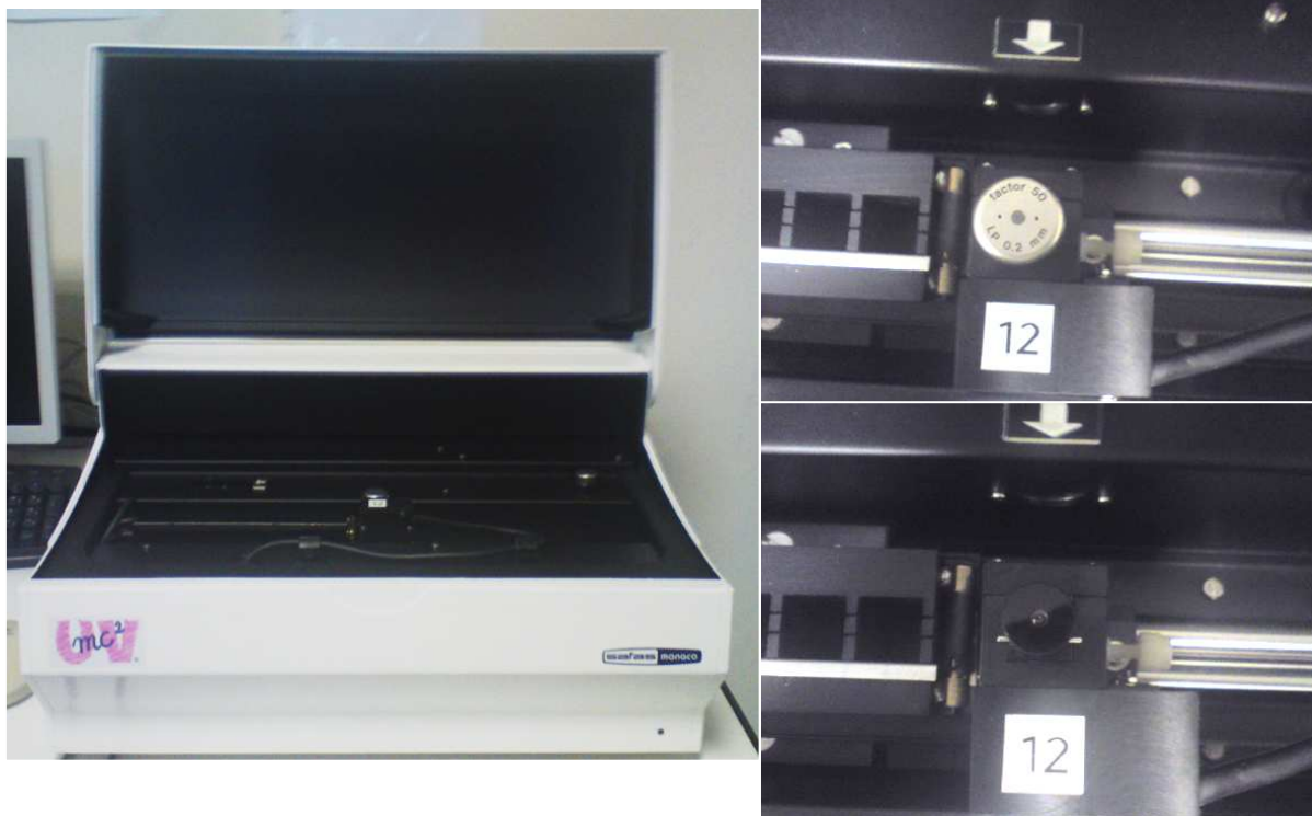
Figure AIII-2 : A gauche : Photo du spectromètre SAFAS (ouvert). En haut à droite : Photo de la microcuve fermée. En bas à droite : Photo de la microcuve ouverte.
