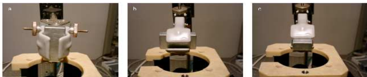
Figure V-2 : Orientations a1 (a), a2 (b) et a3 (c) de l'aimant maintenu par le bras mécanique. Les pôles nord et sud sont situés sur les grandes faces de l'aimant.
